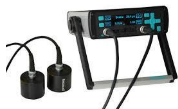
Figura 2: Aparelho para o ensaio de velocidade de propagação de ondas ultrassônicas.
