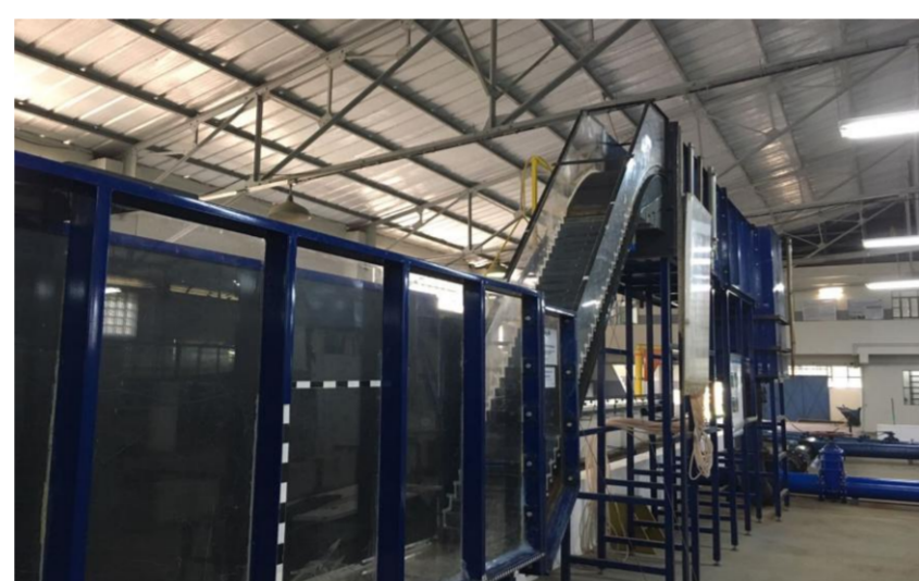
Figura 2 - Modelo físico de vertedouro em degraus utilizado no projeto - Laboratório de Obras Hidráulicas - IPH/UFRGS
