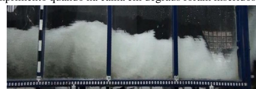
Figura 8 - Ressalto hidráulico a jusante de vertedouro em degraus com aeração natural.
