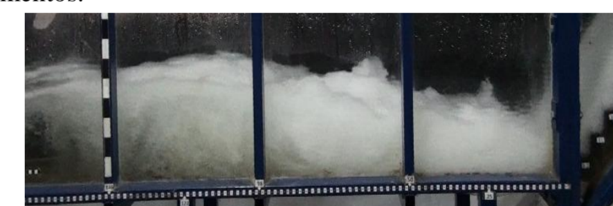
Figura 9 - Ressalto hidráulico a jusante de vertedouro em degraus com aeração forçada por pilares e defletor.
