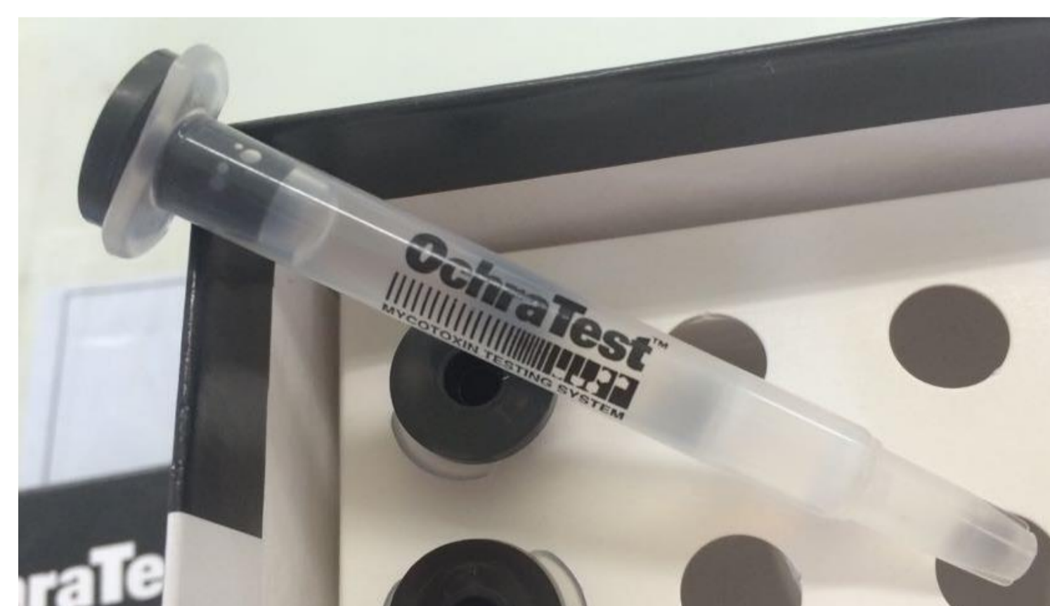
Figura 2. Coluna de imunoafinidade Ochratest™WB da VICAM.
