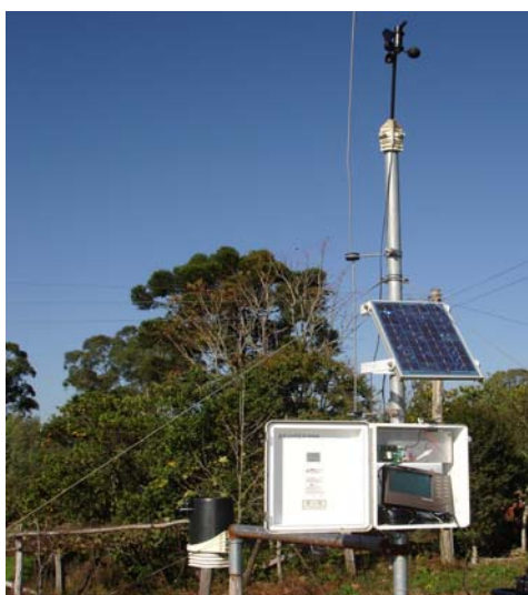
Figura 3.8: Estação meteorológica (Davis®) instalada na bacia de Arvorezinha.
