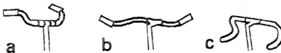
Figura 14: Três diferentes tipos de guidão utilizados. Onde, a: guidão alto, b: guidão reto e c: guidão de competição.
