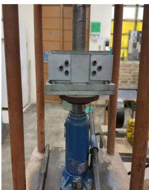
Compactação da mistura no molde de 170 mm de comprimento e 40 mm de altura e 40 mm de largura, utilizando-se macaco hidráulico.
