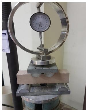
Ensaio de tração na flexão, por meio de um carregamento de quatro pontos.
