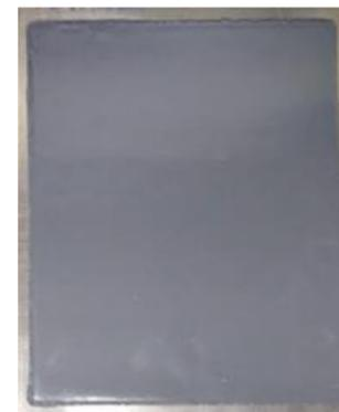
**Tinta intumescente aplicada em substrato metálico**
