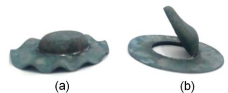
Figura 4 – Comparação da atuação de diferentes pressões de atuação no prensa chapas para matriz e punção com raios de 6mm. (a) Pressão 0MPa. (b) Pressão 3MPa.
