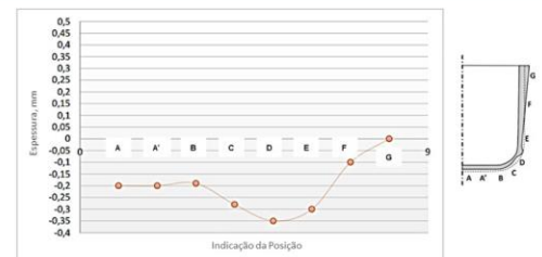
Figura 7 – Perfil gráfico da variação de espessura na peça estampada (a) e indicação dos pontos utilizados para medição.
