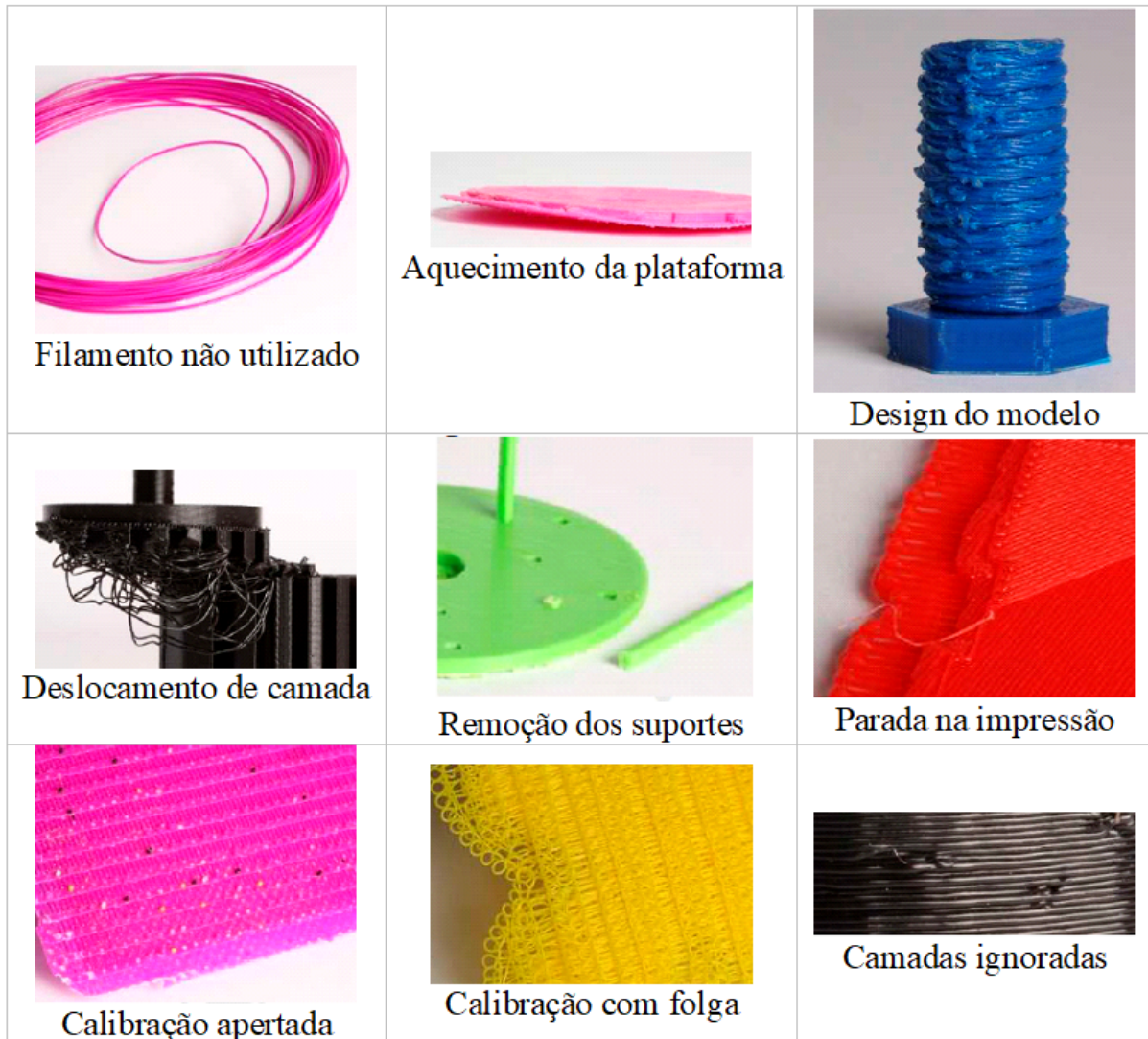
Figura 3 – Imagem dos tipos de falha no processo FDM.
