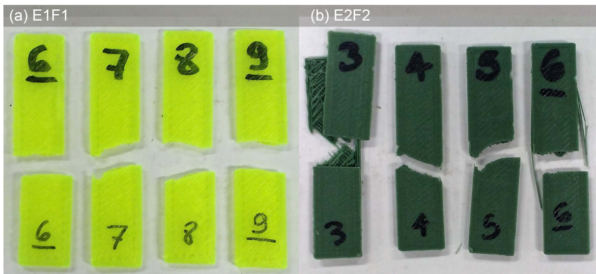
Figura 35 – Corpos de prova de PLA pós ensaio de impacto.
