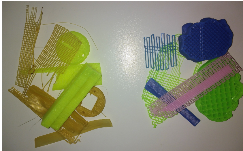
Figura 13 – Imagem das rebarbas e peças descartadas após impressão por FDM.
