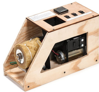
Figura 15 – Extrusora utilizada durante o processamento dos filamentos.
