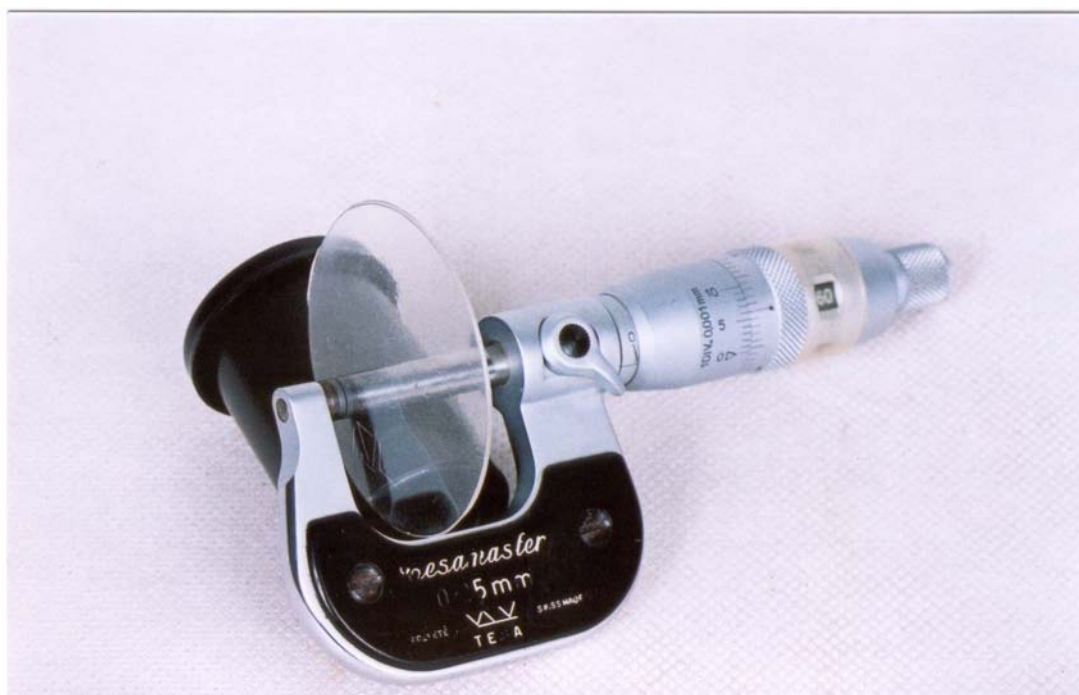
FIGURA 6 – Micrômetro Tesamaster (TESA, Swiss ), com resolução de 0,001mm.
