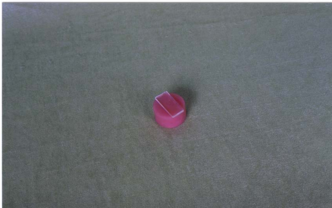
FIGURA 7 – Corpo de prova de resina acrílica montado para o ensaio de microdureza Knoop.
