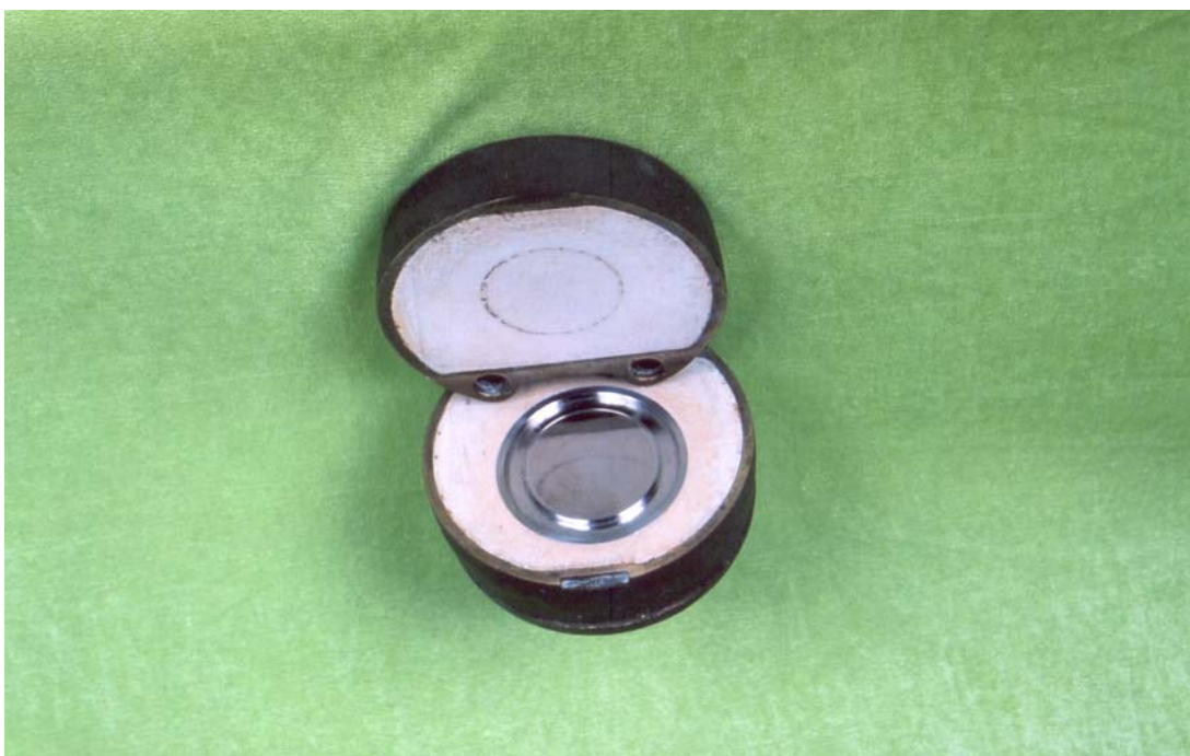
FIGURA 2 – Matriz de aço inoxidável, incluída num muflo metálico.
