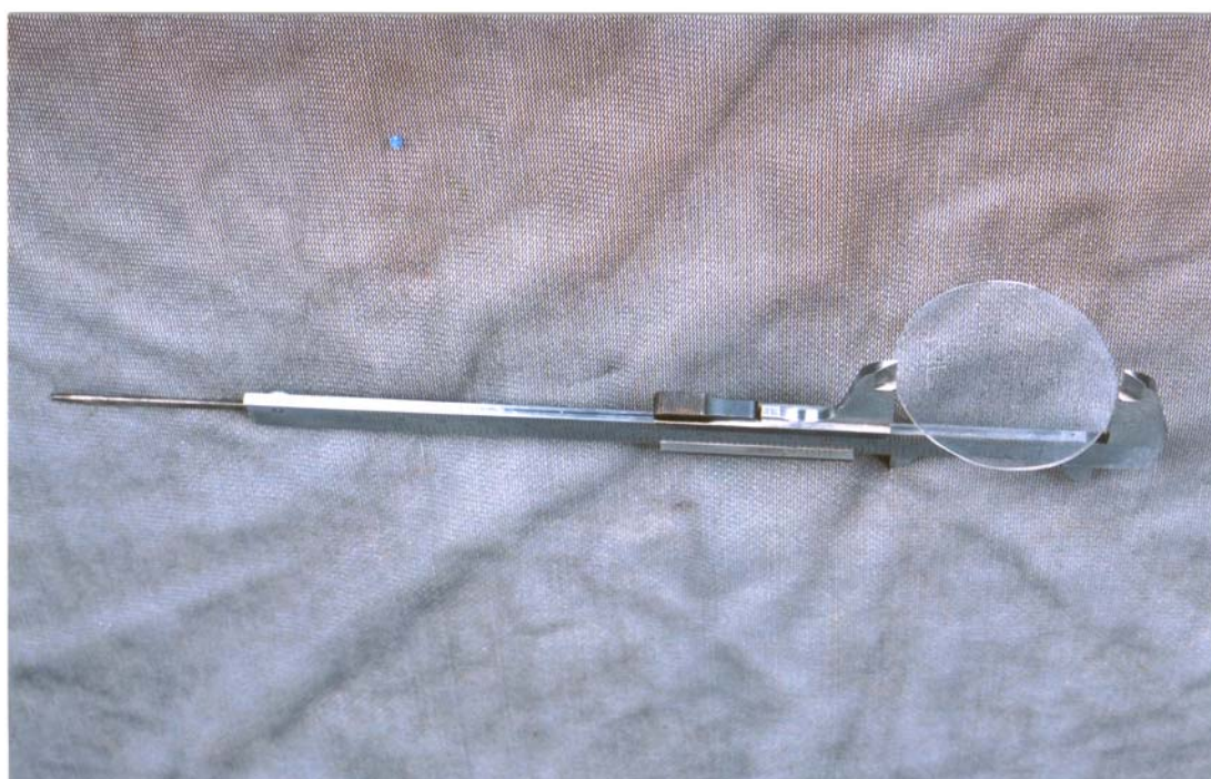
FIGURA 5 – Paquímetro metálico com resolução de 0,001mm.
