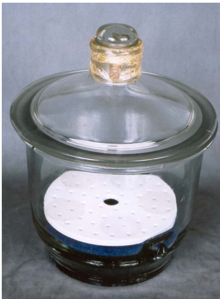
FIGURA 4 – Dissecador contendo sílica gel azul desidratada (Labsynth Produtos para Laboratórios Ltda., Diadema, S.P.).
