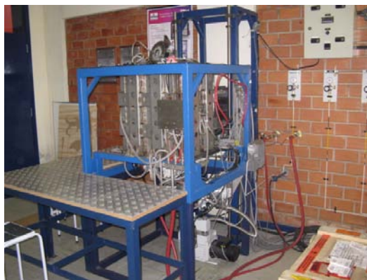
Figura 34. Forno resistivo utilizado no ensaio de redução-fusão.
