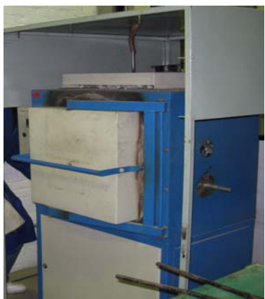
Figura 26. Forno mufla utilizado nos ensaios.
