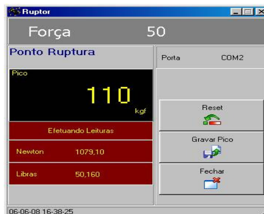
Figura 25. Tela de leitura do ponto de ruptura.
