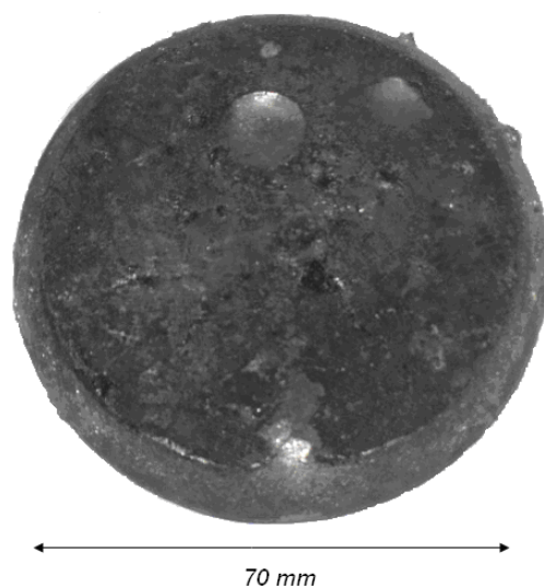
Figura 57. Liga ferrosa obtida no ensaio de redução-fusão.
