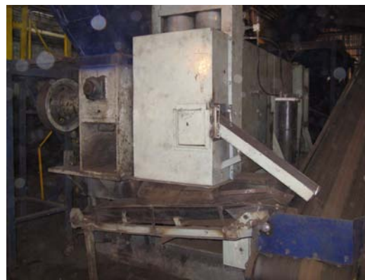
Figura 23. Equipamento de briquetagem.
