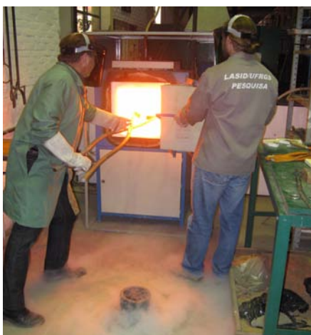
Figura 31. Retirada do cadinho do forno.
