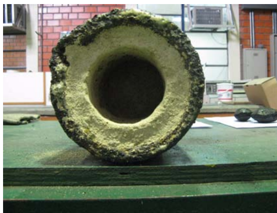
Figura 27. Cadinho de grafita revestido com refratário de sílica e alumina.
