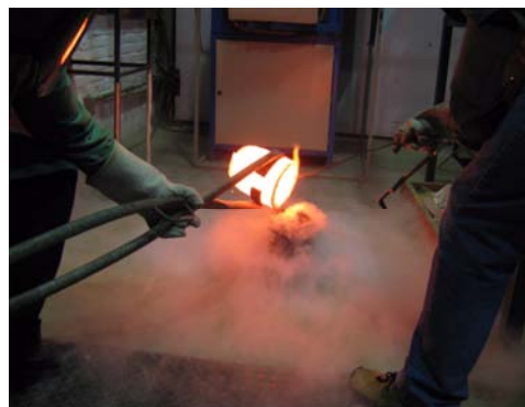
Figura 32. Resfriamento em nitrogênio líquido.
