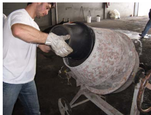
Figura 18. Homogeneização da mistura das carepas.
