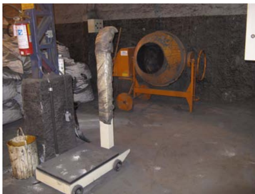
Figura 22. Balança e betoneira utilizadas na confecção dos briquetes.
