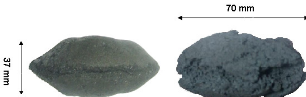
Figura 48. Briquete reduzido a 1200^{\circ}\text{C} , à direita, apresentando inchamento
