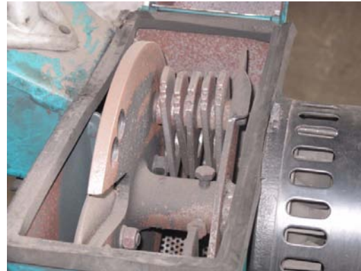
Figura 20. Aspecto interno do moinho utilizado.
