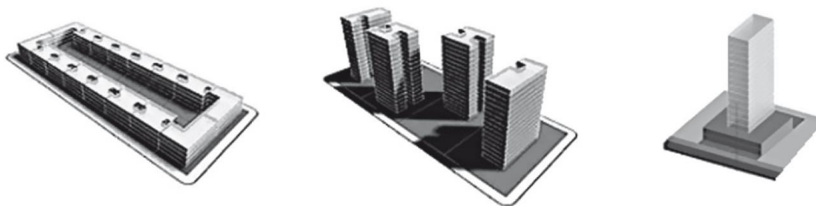
Figura 3.17 – Tipo Contínuo, Tipo Isolado e Tipo Híbrido (Fonte: NETTO, VARGAS e SABOYA, 2012)
