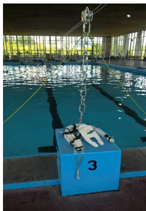
Figura 4 – Cabo de aço, correntes, mosquetões, cordas e suporte do Analisador de gases K5® COSMED®.
