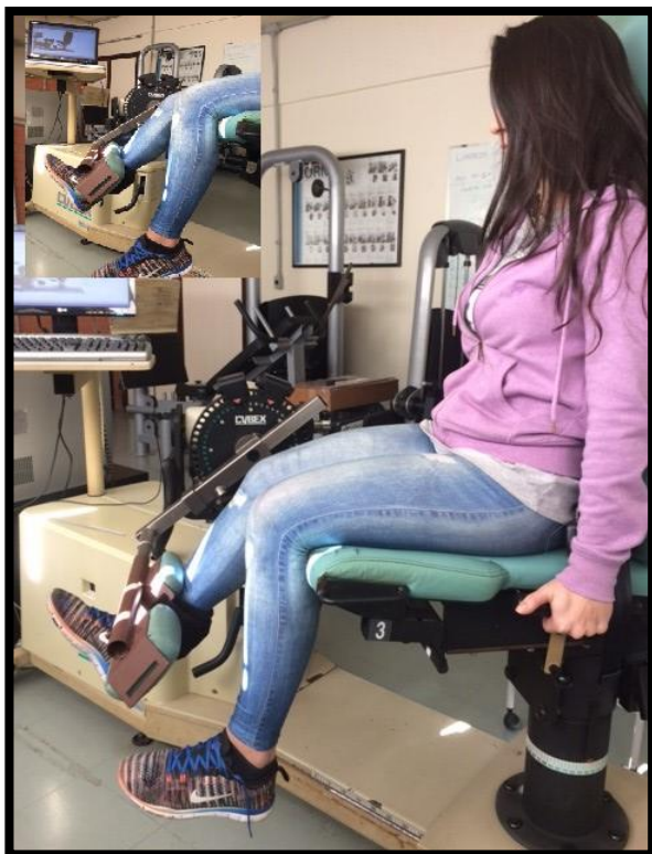
Figura 7: Posicionamento da CIVM de Flexão e Extensão do quadril no equipamento isocinético CYBEX Norm (Ronkonkoma, NY, USA).
