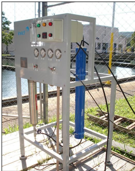
Figura 16: Sistema de membranas de nanofiltração instalado e em operação.
