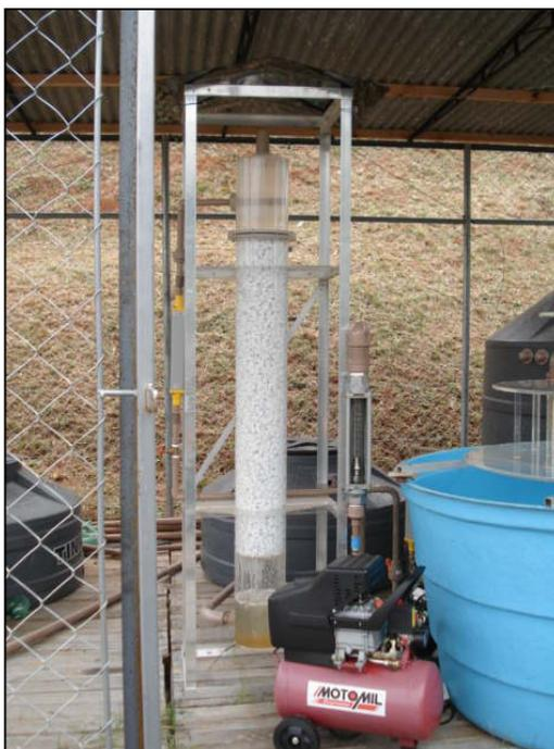
Figura 15: Torre de dessorção em operação.
