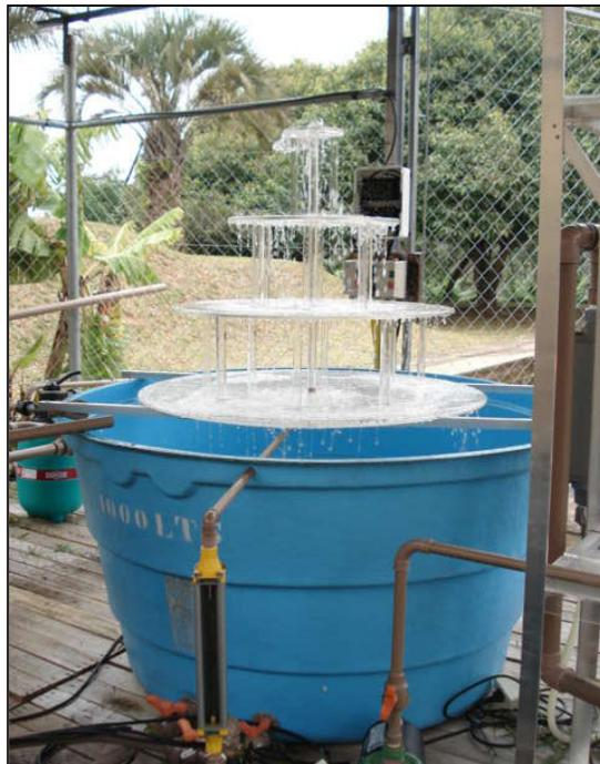
Figura 13: Aerador em funcionamento.
