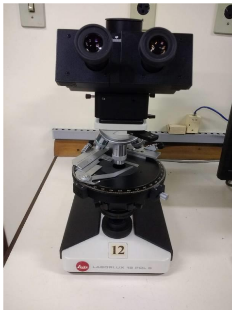
Figura 3 - Microscópio Leitz Laborlux (aumentos de 2.5, 4.3, 16 e 40 vezes) com charriot, utilizado na descrição das lâminas delgadas.
