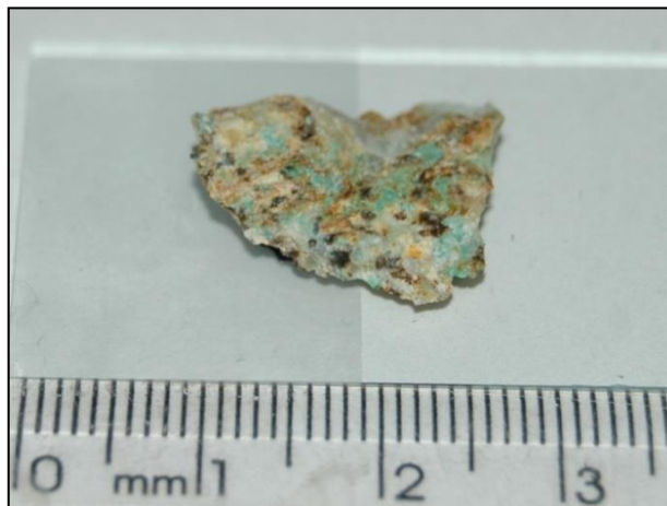
Figura 56 - Fotografia do fragmento MB, fraturado para observação topográfica e metalizado com ouro. Foto: Autor.
