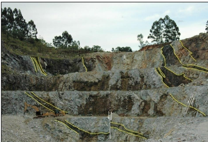
Figura 21 - Vista geral da pedreira com os contatos entre as intrusões e o mármore destacados em amarelo e uma falha observada na parte central inferior da foto. Foto: Autor.
