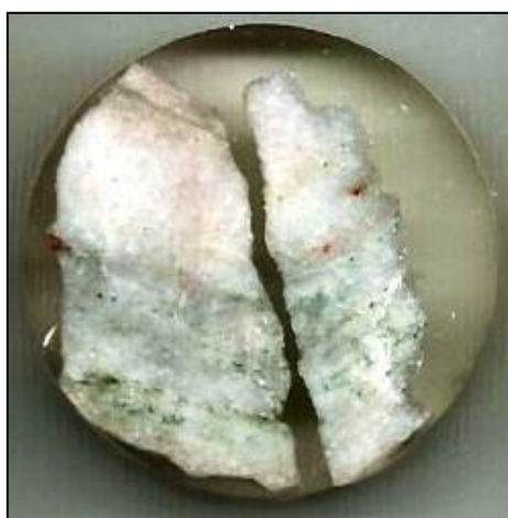
Figura 37 – Foto de um fragmento de mármore (branco) com bandas de clorita (verde) e óxidos (pontos vermelhos). Diâmetro do plug é 2,5 cm. Foto: Autor.
