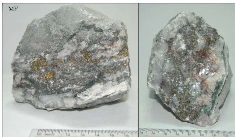
Figura 28 - Amostra da brecha sob dois pontos de vista. O mármore na borda possui talco e serpentina enquanto que a porção central possui calcita, clorita e sulfetos alterados. Fotos: Autor.
