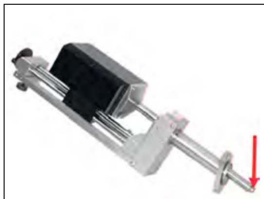
Figura 10 - Detector de raios X característicos do tipo SDD (do inglês silicon drift detector ). A seta vermelha indica a localização da parte ativa do detector de raios X. Fonte: VASCONCELLOS e HINRICHS, 2014.
