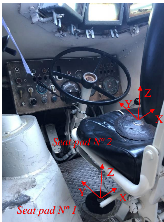
Figura 4.2 - Instrumentação realizada em um dos veículos de análise (Urutu), com indicação da direção e sentido dos eixos cartesianos. Usou-se, aqui, o medidor desenvolvido pelo Projeto de Instrumentação Mecânica do GMAp – UFRGS.
