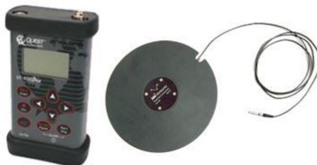
Figura 4.1 - Quest VI400Pro, utilizado para as medições nas viaturas blindadas sob rodas.
