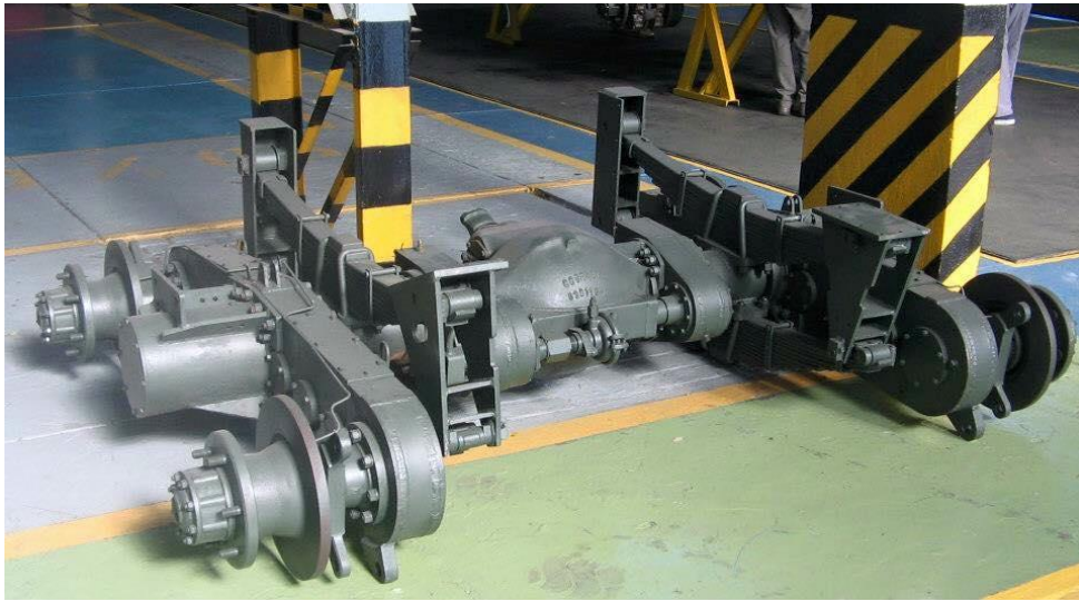
Figura 2.1 - Sistema de suspensão do tipo boomerang . [BASEOFFROAD, 2016]
