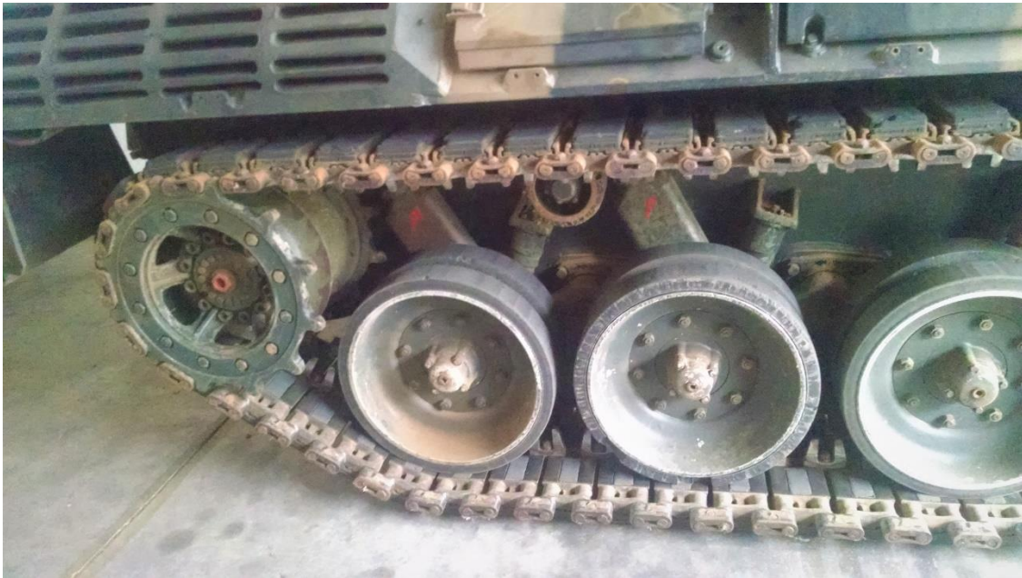
Figura 2.5 - Sistema de suspensão e amortecimento do Veículo Blindado de Combate Carro de Combate (VBC CC) Leopard 1 A5BR.
