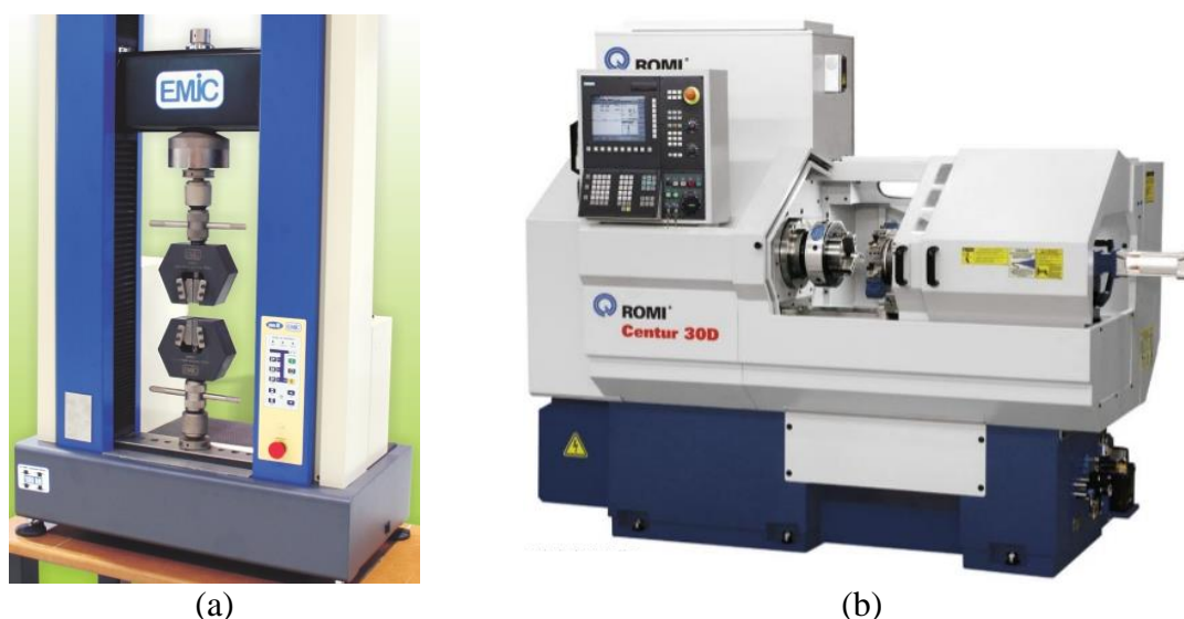
Figura 3.4 – Equipamentos utilizados para caracterização do material: (a) máquina universal para ensaio de tração Emic DL-3000; (b) torno CNC Romi Centur 30D
