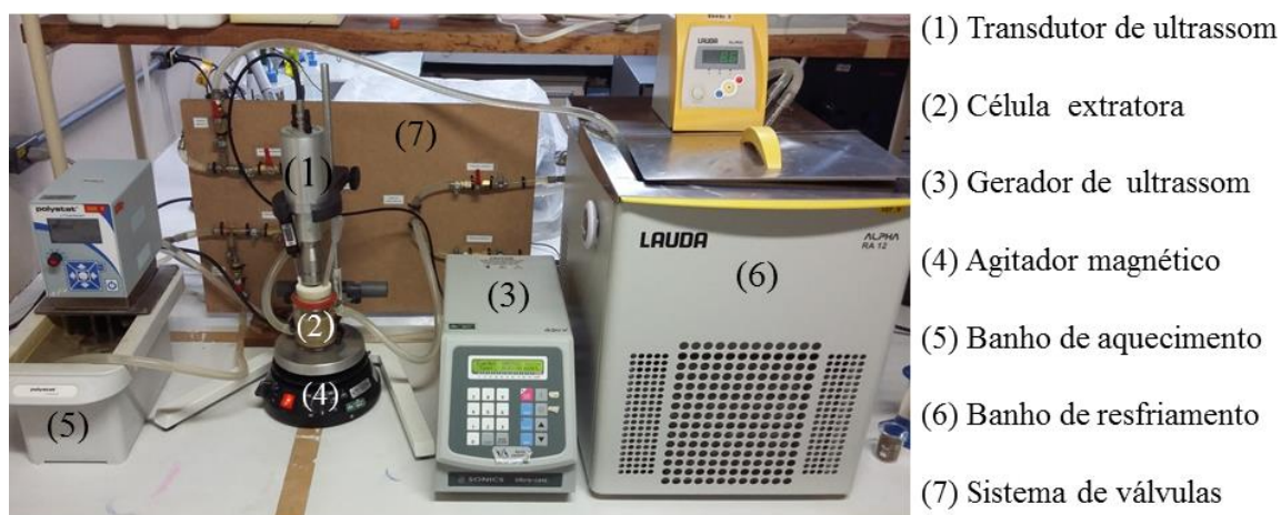
Figura 3.2 Aparato experimental para extração de compostos fenólicos da torta de semente de girassol e canola. Fonte: Autor.
