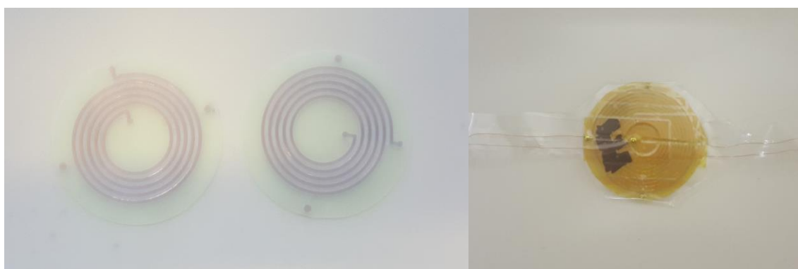
Figura 3.7 Bobinas oriundas de placas PCB (a) após a fresagem e (b) unidas no sensor finalizado.
