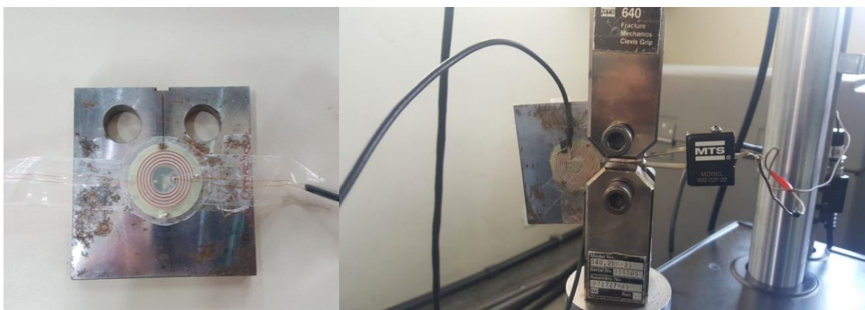
Figura 3.10 Arranjo experimental ensaio de propagação de fadiga para detecção de propagação de trinca.
