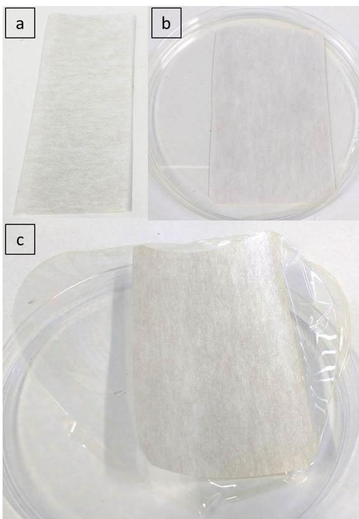
Figura 39. Aspecto visual do suporte (a), da membrana com apenas um lado em contato com a solução de quitosana (b) e a membrana composta após a secagem (c).
