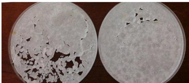
Figura A1. Fotografia da estrutura obtida a partir da solubilização da quitosana com solução de ácido cítrico 1,0 M, 1 g/100 mL, secagem a 35 °C e gramatura 0,34 g.cm<sup>-2</sup>.
