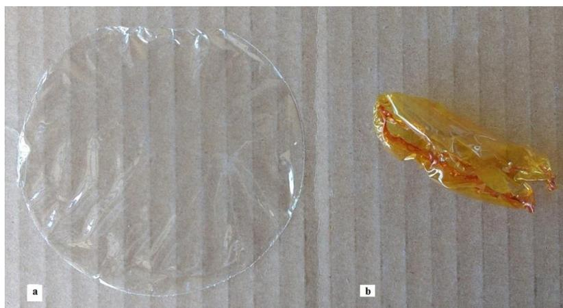
Figura 28. Aspecto visual dos filmes fabricados com ácido láctico não reticulado (a) e reticulado com 10 % (m/m) de glutaraldeído (b).
