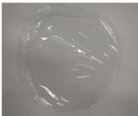
Figura A3. Fotografia do filme obtido a partir da solubilização da quitosana com solução de ácido acético 1% (v/v), 1 g/100 mL, secagem a 35 °C e gramatura 0,34 g cm<sup>-2</sup>.
