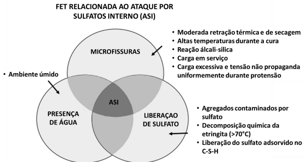
Figura 9: Modelo holístico alternativo proposto para a formação de etringita tardia devido ao ataque por sulfato de fontes internas de sulfato
