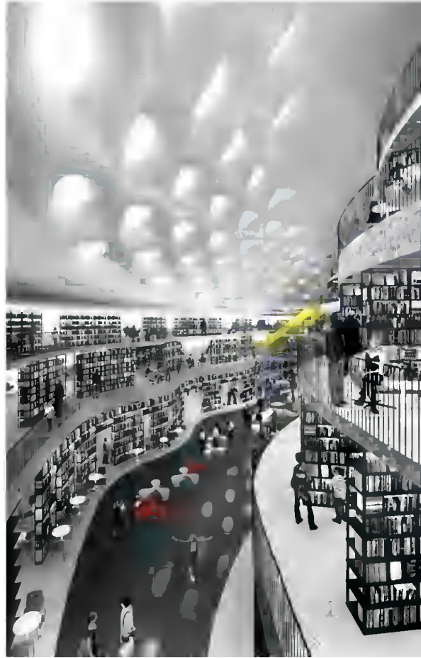
3.2.130 _ O átrio e o escalonamento das lajes favorecendo a iluminação zenital;
