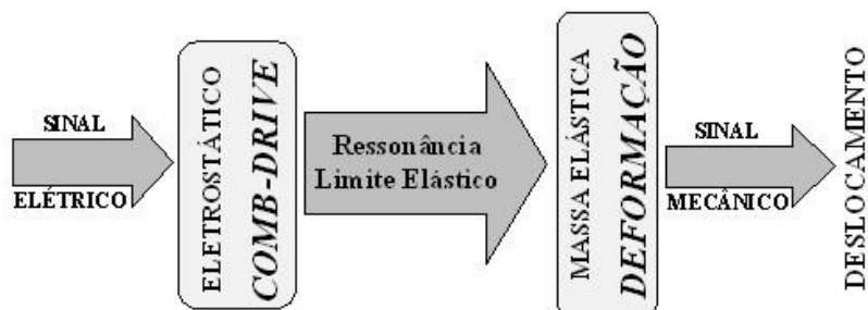
Figura 2.5: Atuador MEMS elasto-deformável e ação eletrostática.
