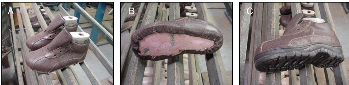
Fig. 34: Processo de fabricação Ecobum. A) Calçados colocados em suas formas. B) Calçado pronto para receber a cola. C) Calçado pronto para receber acabamento.
