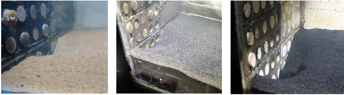
Figura 26: Ensaios realizados com três diferentes tipos de materiais, areia, carvão e borracha, respectivamente, para a vazão de 4,20 l/s, para a descarga de fundo nas posições 20, 19, 14 e 15. (ABREU et al., 2016)
