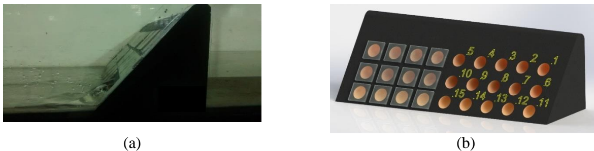
Figura 25: (a) Vista lateral do modelo com descarga de fundo aberta na posição 12 (b) Numeração das posições das descargas de fundo ( ABREU et al., 2015).
