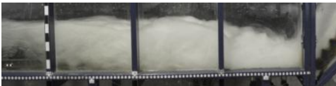
Figura 12. – Ressalto hidráulico a jusante de vertedouro em degraus com aeração forçada por pilar mais defletor.
