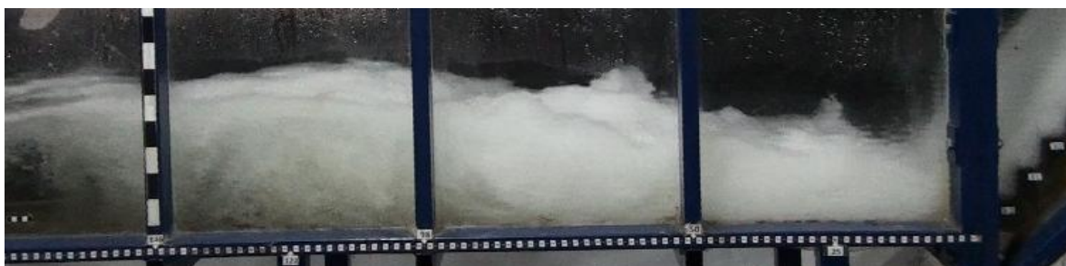
Figura 10. – Ressalto hidráulico a jusante de vertedouro em degraus com aeração forçada por pilares e defletor.
