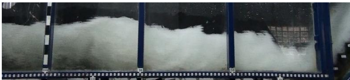
Figura 9. – Ressalto hidráulico a jusante de vertedouro em degraus com aeração natural.
