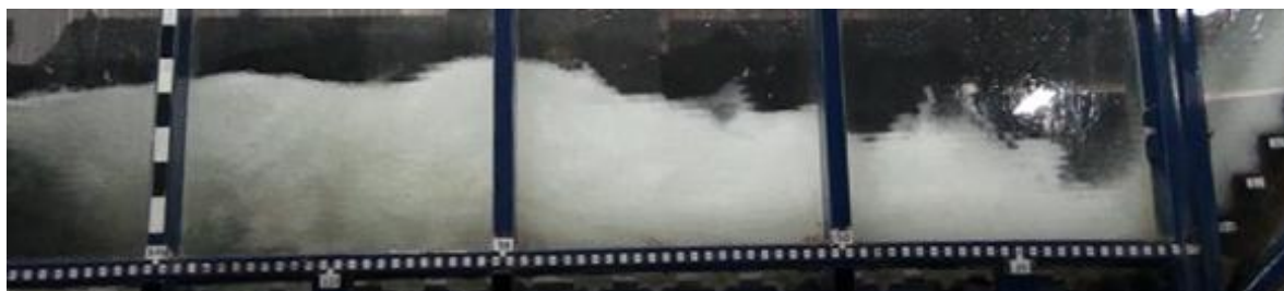
Figura 11. – Ressalto hidráulico a jusante de vertedouro em degraus com aeração forçada por aerador.
