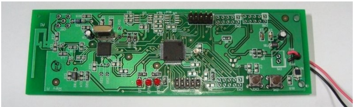
Figura 14 Placa Montada de um Nó da Rede
