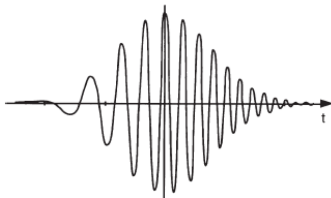
Fig. 4.3: Evolução temporal do campo elétrico em um pulso gaussiano que apresenta uma dependência temporal quadrática em sua fase \phi .
