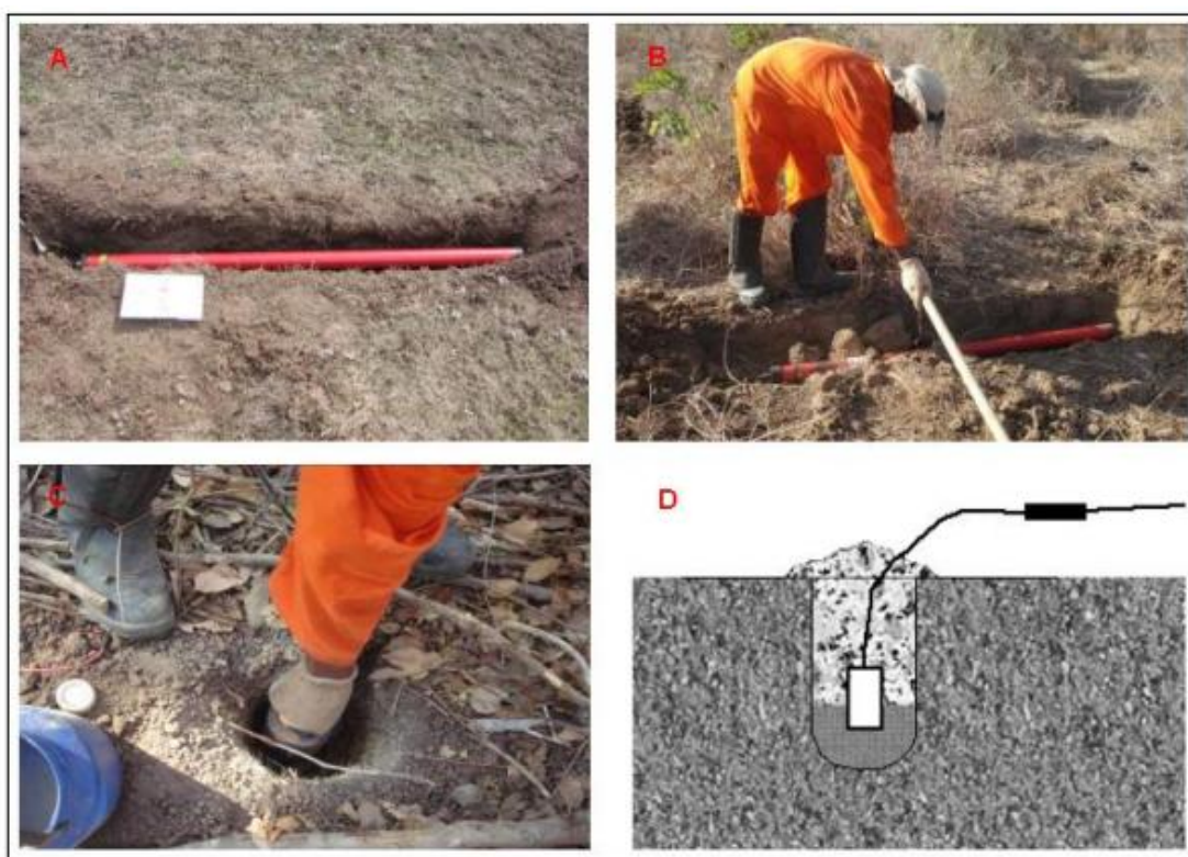
Figura 10. Montagem do equipamento. A, B – Alinhamento e nivelamento das bobinas (sensores magnéticos). C – Preparação de uma solução com água e sal para colocar o eletrodo. D – Disposição esquemática do eletrodo em sub-superfície.
