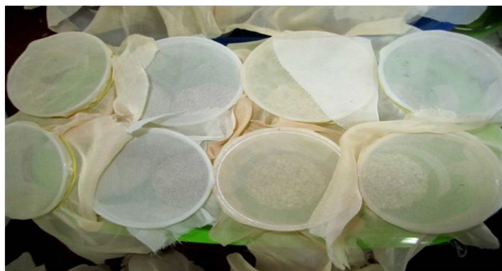
Figura 6. Recipientes de 300 mL contendo 100 gramas de grãos de arroz com casca tratados com terra de diatomácea e infestados com 20 adultos de Sitophilus zeamais .
