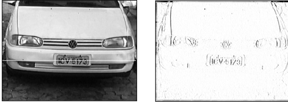
Fig. 6.4 – Imagem original e saída do operador Sobel
