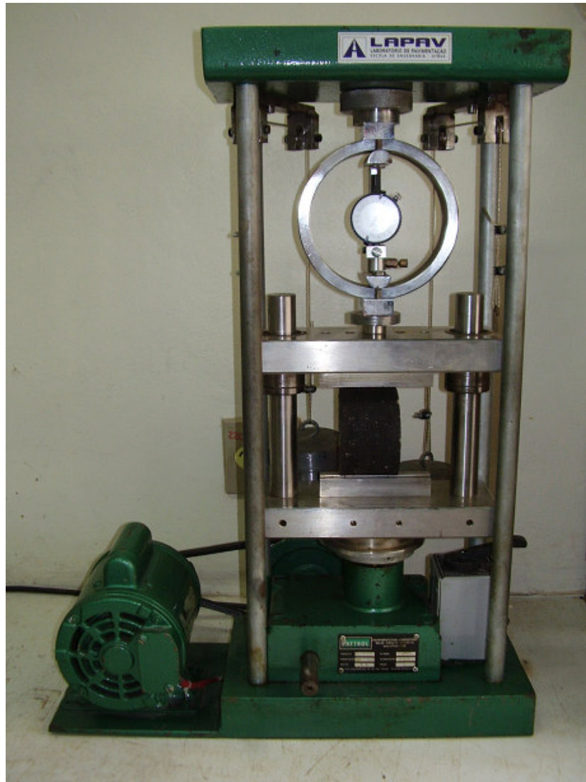
Figura 3.6: Equipamento para ensaio de resistência a tração por compressão diametral em misturas asfálticas do LAPAV
