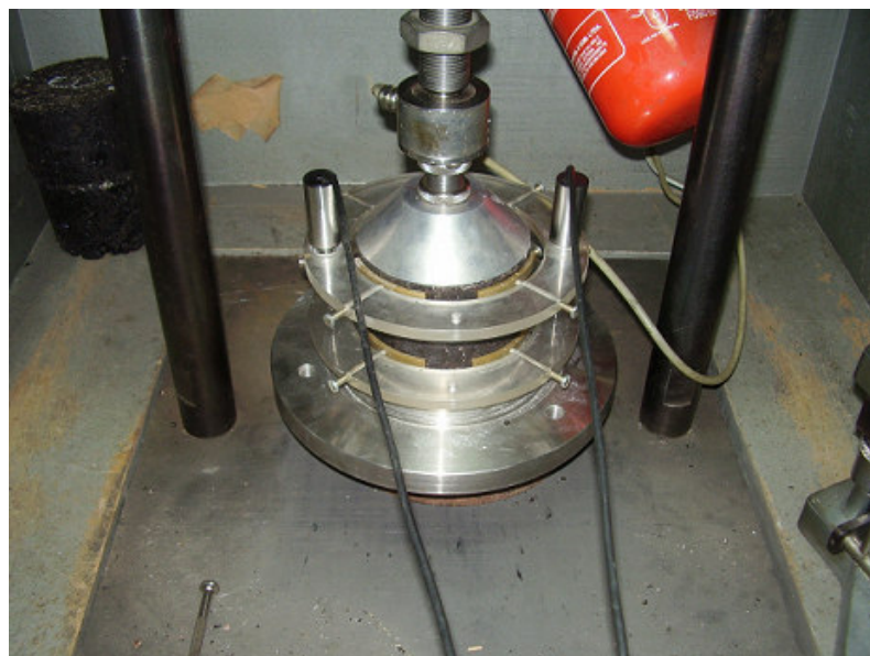
Figura 3.10: sistema de fixação dos transdutores tipo LVDT na amostra do ensaio de fluência por compressão uniaxial dinâmico
