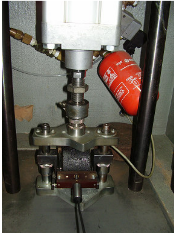
Figura 3.9: Equipamento para ensaio de módulo de resiliência de misturas asfálticas do LAPAV
