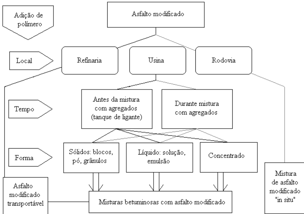
Figura 2.3: Alternativas de asfalto modificado por polímeros (ZENKE 3 , 1979 apud LEITE, 1999)
