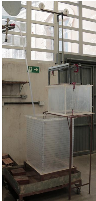
Figura 4.9 – Estrutura utilizada para o sistema de contrapesos e ensaios de arrancamento
