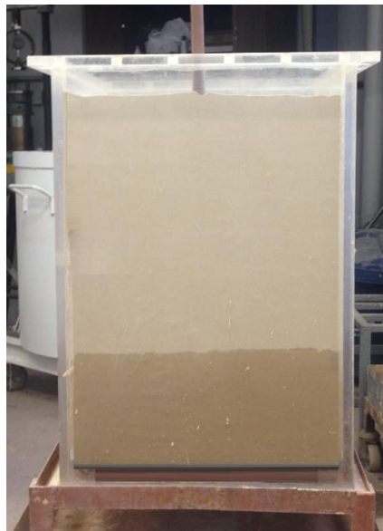
Figura 4.12 – Saturação da areia no tanque
