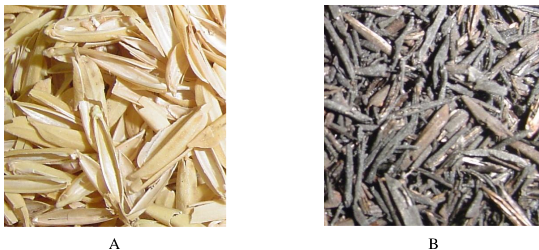
Figura 3.10: (A) casca de arroz antes da pirólise e (B) fração sólida resultante do processamento pirolítico a 700°C. Ampliada 5 vezes.
