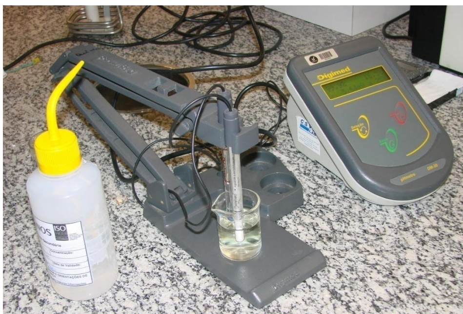
Figura 3.18: Sistema para medição de pH com pHmetro digital
