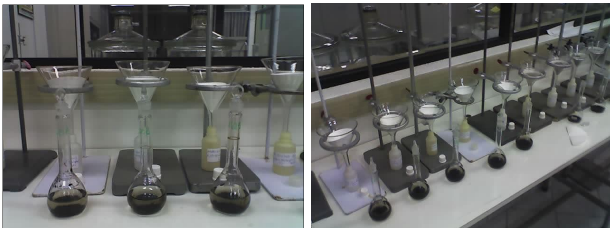
Figura 3.14: Sistemas de filtração
