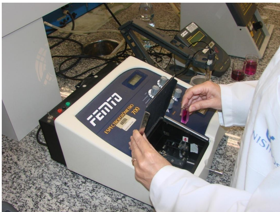
Figura 3.17: Análise espectrofotométrica do Cr(VI)
