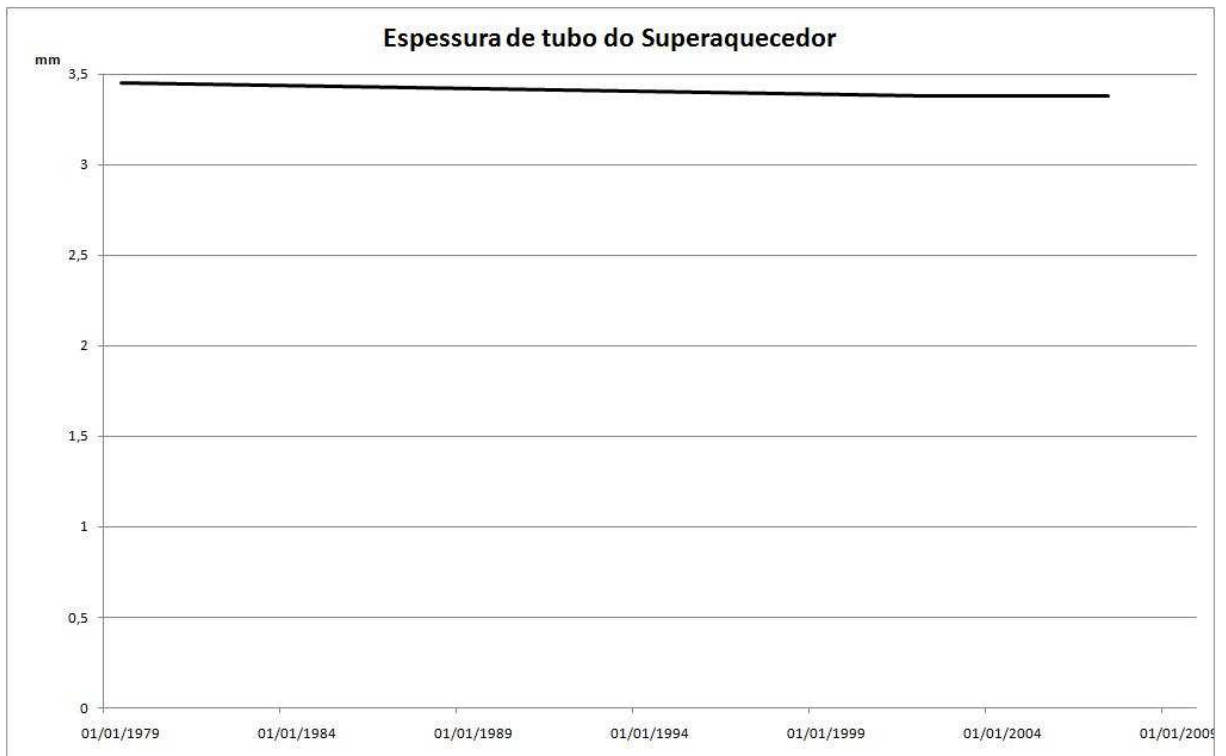
Figura 5.3 Espessura de tubo do superaquecedor.
