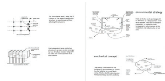
K102. Brochura explicativa da proposta do OMA para a Casa da Música. Porto. Rem Koolhaas/OMA, junho de 1999. Estrutura do auditório principal e instalações, pg. 62-63.
