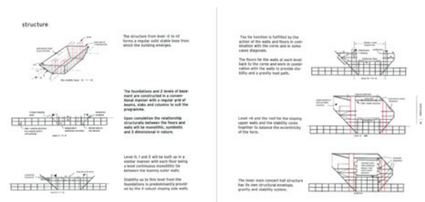
K101. Brochura explicativa da proposta do OMA para a Casa da Música. Porto. Rem Koolhaas/OMA, junho de 1999. Estrutura e o processo construtivo, pg. 60-61.
