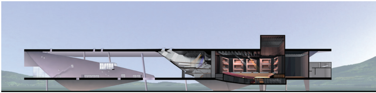
P098. Desenvolvimento do anteprojeto da Cidade das Artes. Rio de Janeiro. Christian de Portzamparc/ACDP. Corte transversal esquemático, passando pela sala principal e foyer.
