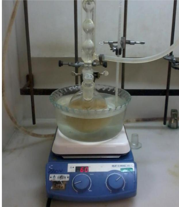
**Figura 7.** Síntese do biodiesel em escala laboratorial.
