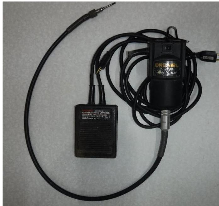
Figura 18 - Motor rotatório com eixo flexível e controle de velocidade no pedal, Dremel Moto-Flex 250w.
