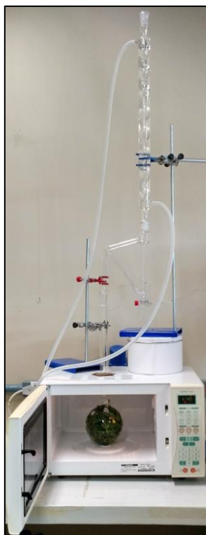
Figura 13. Adaptação do forno doméstico de micro-ondas para a extração de óleo essencial.
