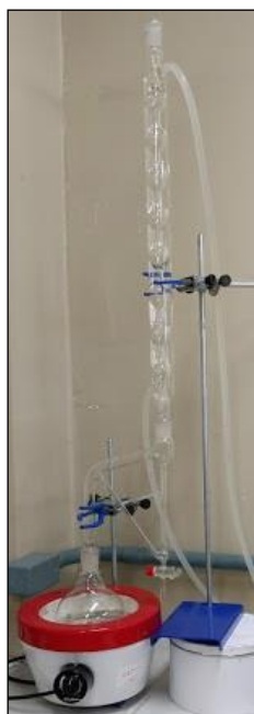
Figura 16. Sistema de extração convencional de óleo essencial com manta de aquecimento elétrica e aparelho de Clevenger.
