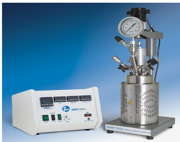
**Figura 8.** Reator Parr utilizado nas reações de oligomerização.
