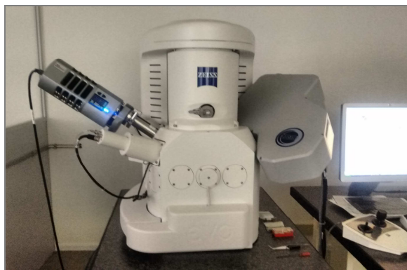
Figura 11: Microscópio eletrônico de varredura com EDS acoplado, no it Fóssil, Unisinos.
