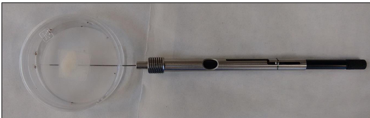
Figura 11. Fibra de SPME exposta a voláteis emitidos a partir do óleo essencial de Eucalyptus saligna em um experimento de volatilização simulado. O procedimento foi repetido durante sete dias, e a cada dia os componentes absorvidos na fibra foram analisados por GC-MS.
