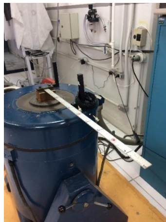
Figura 4.22 – Viga utilizada para os ensaios experimentais.
