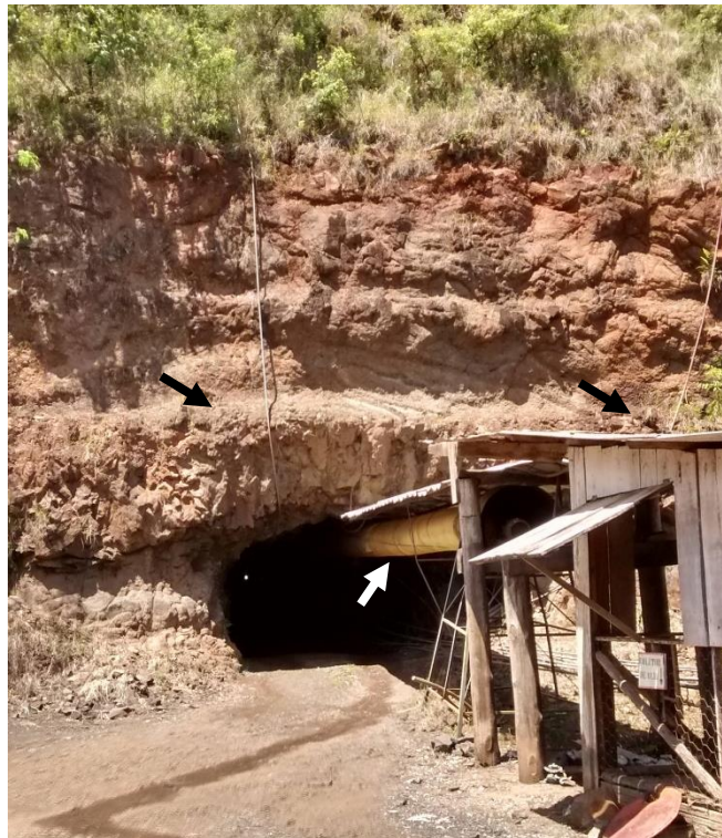
Figura 5. Entrada de um dos garimpos. Pode-se observar o equipamento de exaustão de ar (flecha de cor branca) e as mangueiras que levam a água utilizada na diminuição da poeira durante o trabalho de perfuração (flechas de cor preta). Fonte: Arquivo pessoal.
