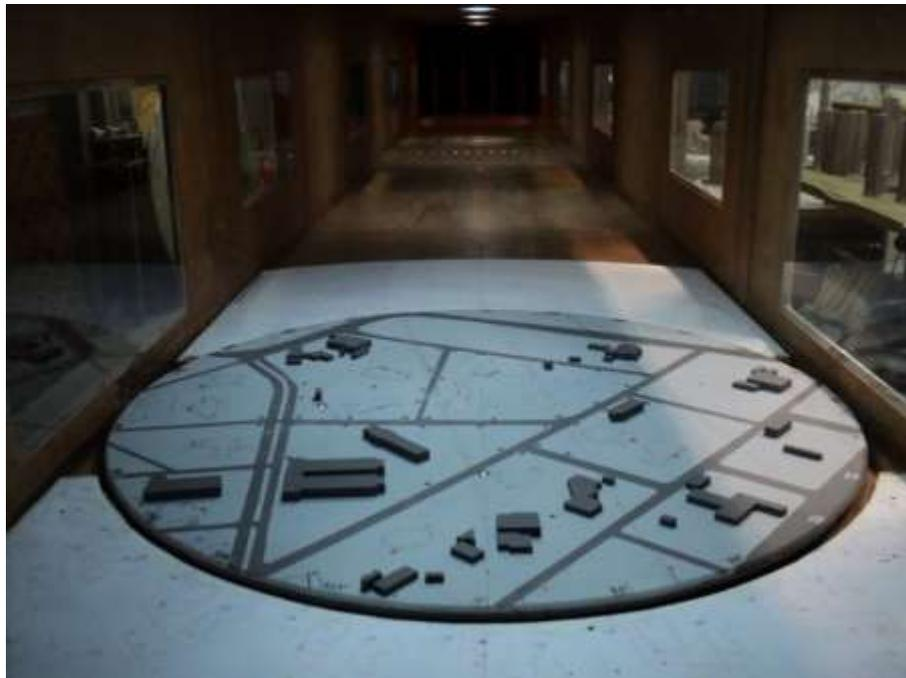
Figura 99: Modelo **M1, adensamento antigo**, no interior do túnel de vento, ensaio **M1.CP** para expoente  $p$  **0,11**, incidência de vento  $180^{\circ}$ , uso de duas mesas auxiliares.
