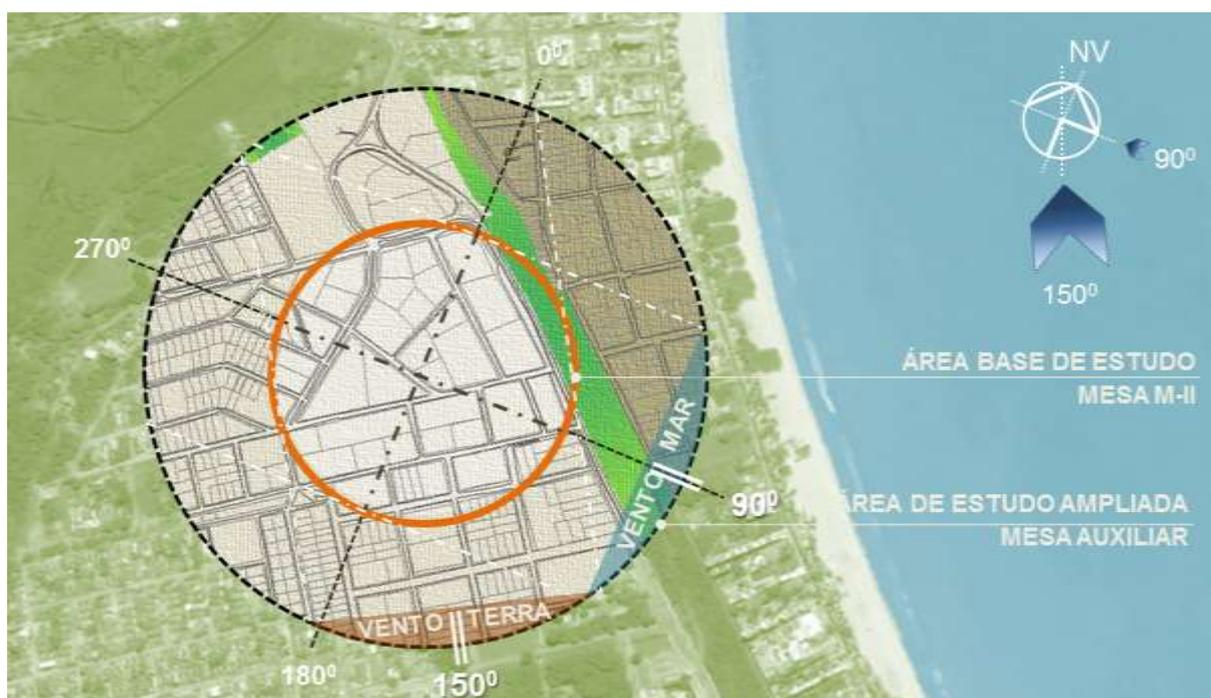
Figura 35: Balizamento da área de estudo, incluindo ângulos de incidência do vento para os experimentos do escoamento.
