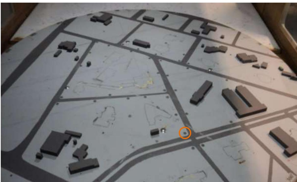
Figura 63: Os 36 sensores omnidirecionais posicionadas no modelo, destacando a sonda 32.
