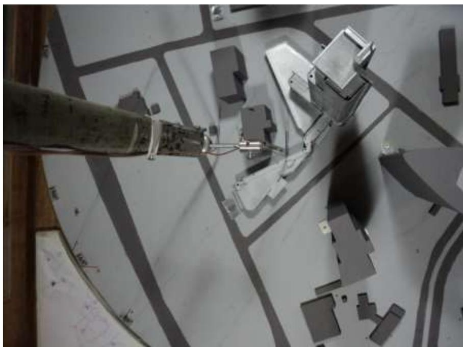
Figura 96: Detalhe do modelo **M2, adensamento recente**, no interior do túnel de vento, vista superior, ensaio **M2.150<sup>º</sup>**, expoente **p 0,23**; posicionamento do instrumentos de medição junto ao modelo, entre edifícios.
