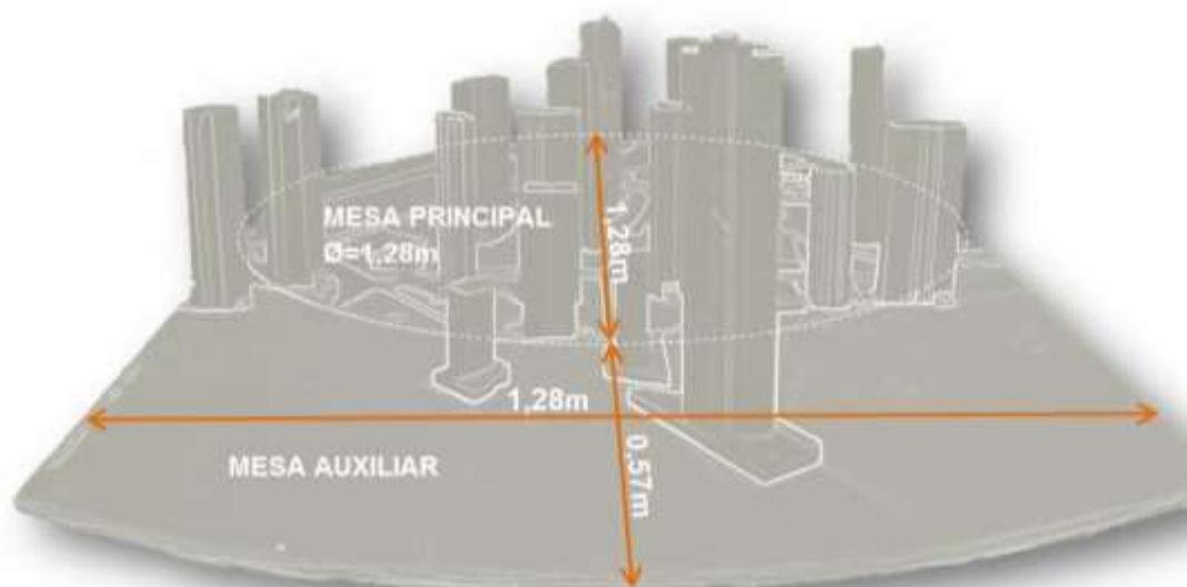
Figura 38: Representação tridimensional esquemática de modelo ensaiado, modelo **M2**, em destaque dimensões adotadas.
