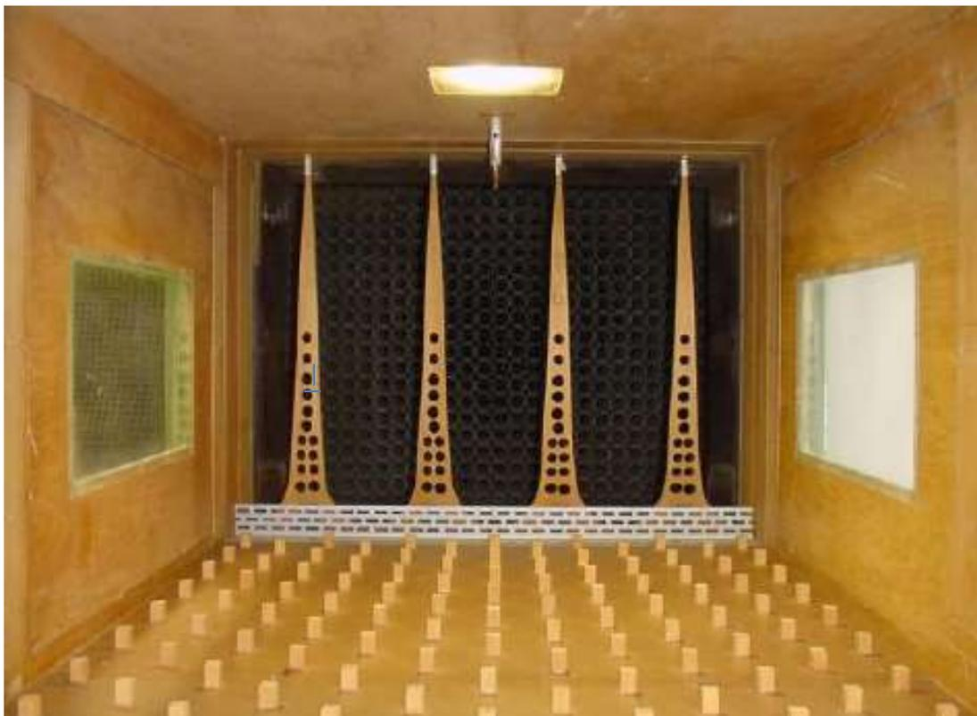
Figura 45: Vista da câmara de simuladores, destacando os dispositivos de geração de camada limite para o expoente  $p = 0,23$ , configuração de ensaio **0,23**.
