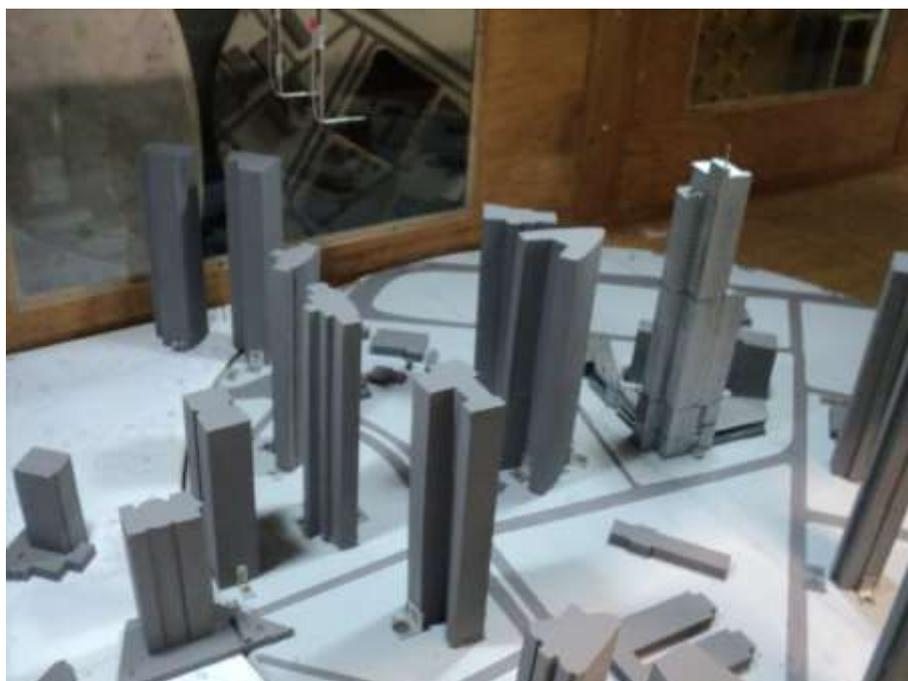
Figura 92: Detalhe do modelo **M2, adensamento recente**, no interior do túnel de vento, ensaio **M2.90<sup>0</sup>**, expoente **p 0,11**; sondas de fio quente fixadas em suportes, medição da altura **H10**.
