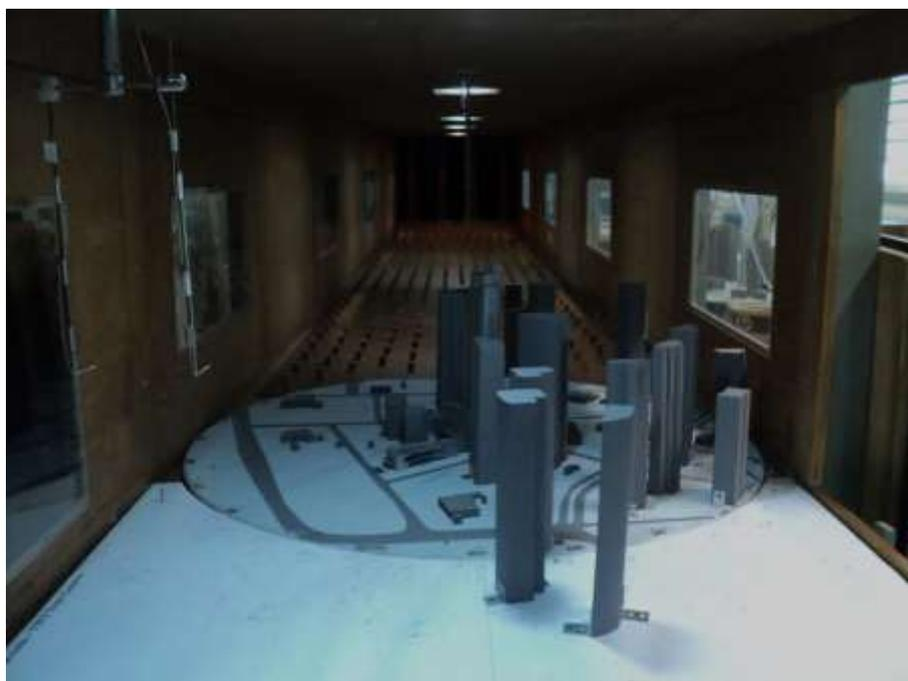
Figura 94: Modelo **M2, adensamento recente**, no interior do túnel de vento, ensaio **M2.150°**, expoente  $p$  **0,23**; visualização dos instrumentos de medição, par de sondas de fio quente fixadas em suportes, lateral esquerda da imagem.
