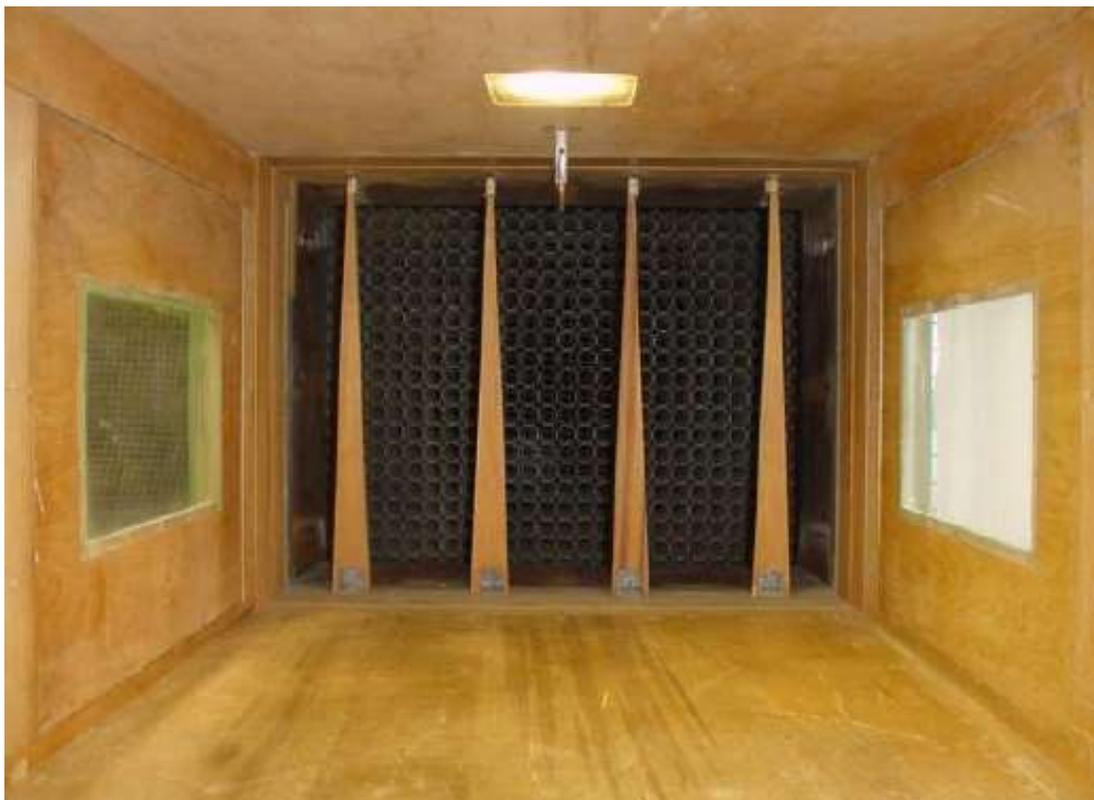
Figura 42: Vista da câmara de simuladores, destacando os dispositivos de geração de camada limite para o expoente  $p = 0,11$ , configuração de ensaio **0,11**. (LOREDO-SOUZA, 2004, p. 150).
