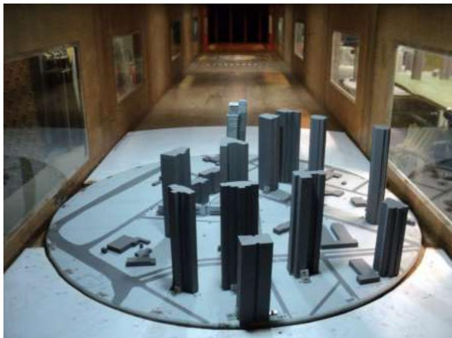
Figura 102: Modelo **M2**, **adensamento recente**, no interior do túnel de vento, ensaios **M2.CP** para expoente  $p$  **0,11**, incidência de vento **90°**, uso de duas mesas auxiliares.
