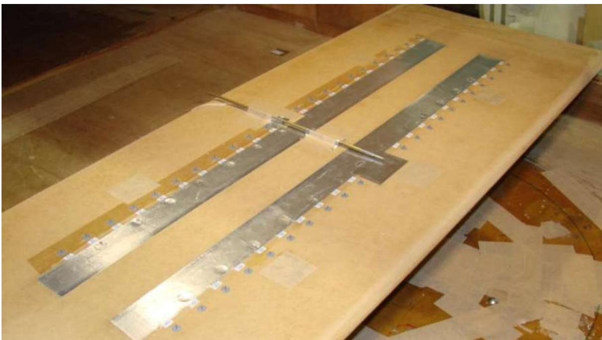
Figura 69: Mesa de calibração das sondas Irwin, usada pelo LAC/UFRGS.
