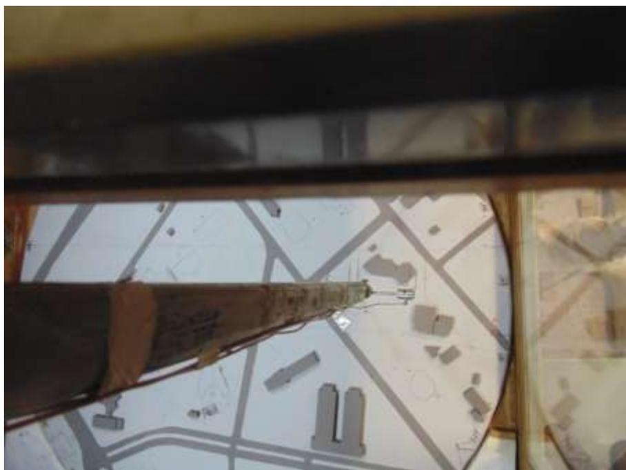
Figura 88: Detalhe do modelo **M1**, **adensamento antigo**, no interior do túnel de vento, vista superior, ensaio **M1.90<sup>0</sup>** para expoente  $p$  **0,11**; instrumentos de medição posicionados na haste do corrdinmetro, suporte para sondas e sondas de fio quente.
