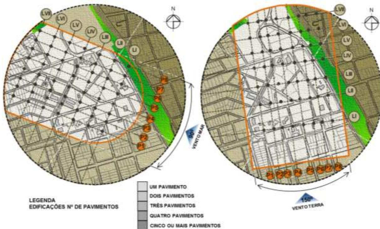
Figura 58: Planta com posicionamento dos pontos para medição para o modelo **M1**, em (a) representação para o rumo de vento  $90^{\circ}$ , **M1.90<sup>0</sup>**; e em (b) representação para o rumo de vento  $150^{\circ}$ , **M1.150<sup>0</sup>**.
