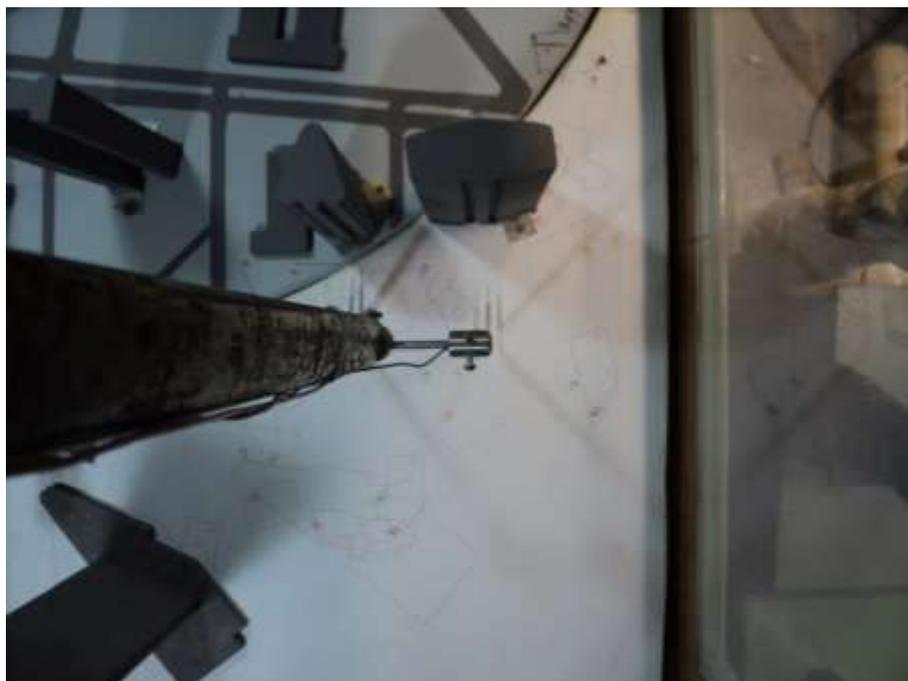
Figura 93: Detalhe do modelo **M2, adensamento recente**, no interior do túnel de vento, vista superior, ensaio **M2.90°**, expoente  $p$  **0,11**; sondas de fio quente junto ao modelo.
