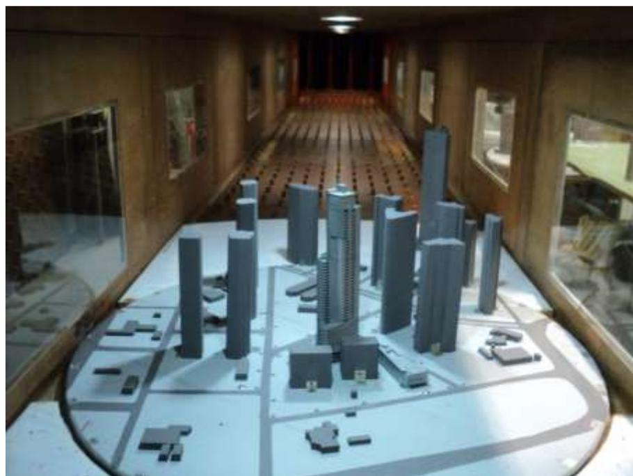
Figura 103: Modelo **M2**, **adensamento recente**, no interior do túnel de vento, ensaios **M2.CP** para expoente  $p$  **0,23**, incidência de vento **315°**, uso de duas mesas auxiliares.
