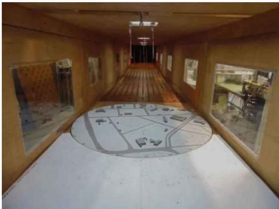
Figura 87: Modelo **M1**, **adensamento antigo**, no interior do túnel de vento, ensaio **M1.150<sup>0</sup>**, expoente  $p$  **0,23**; visualização dos instrumentos de medição, em primeiro plano, no centro e acima, par de sondas de fio quente fixadas em suportes.
