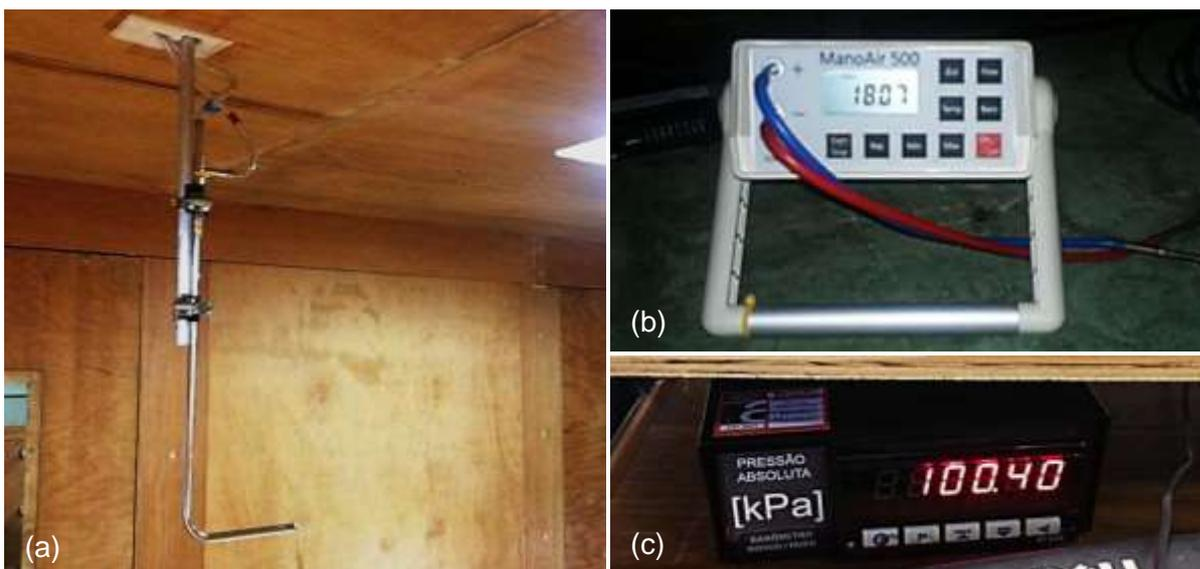
Figura 49: Em (a) vista do tubo de Pitot Prandtl posicionado no túnel; e em (b) micro manômetro eletrônico ManoAir 500 e mangueiras de conexão com o instrumento utilizado; e em (c) barômetro.
