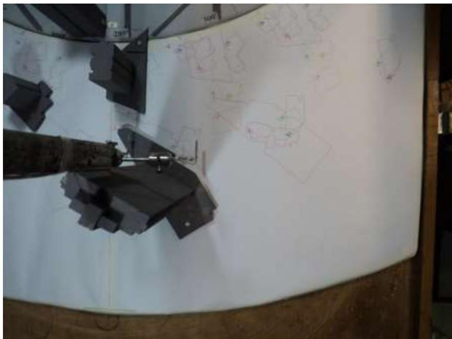
Figura 97: Detalhe do modelo **M2, adensamento recente**, no interior do túnel de vento, vista lateral, ensaio **M2.150<sup>0</sup>**, expoente p **0,23**; posicionamento dos instrumentos de medição junto ao modelo, medições próximas a edifício.
