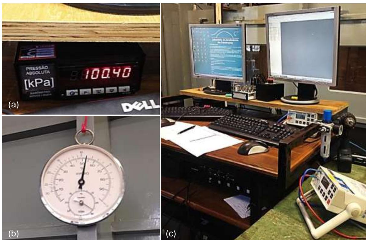
Figura 60: Aparelhos de leitura e aquisição de dados, em (a) barômetro eletrônico; em (b) higrômetro analógico; e em (c) conjunto de aquisição de dados, destacando dois micro manômetros eletrônicos ManoAir 500.
