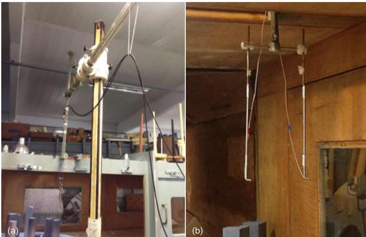
Figura 56: Em (a) coordenômetro posicionado para ensaios; e em (b) par de sonda – fio quente em suportes, fixadas na haste do coordenômetro para realização dos ensaios.
