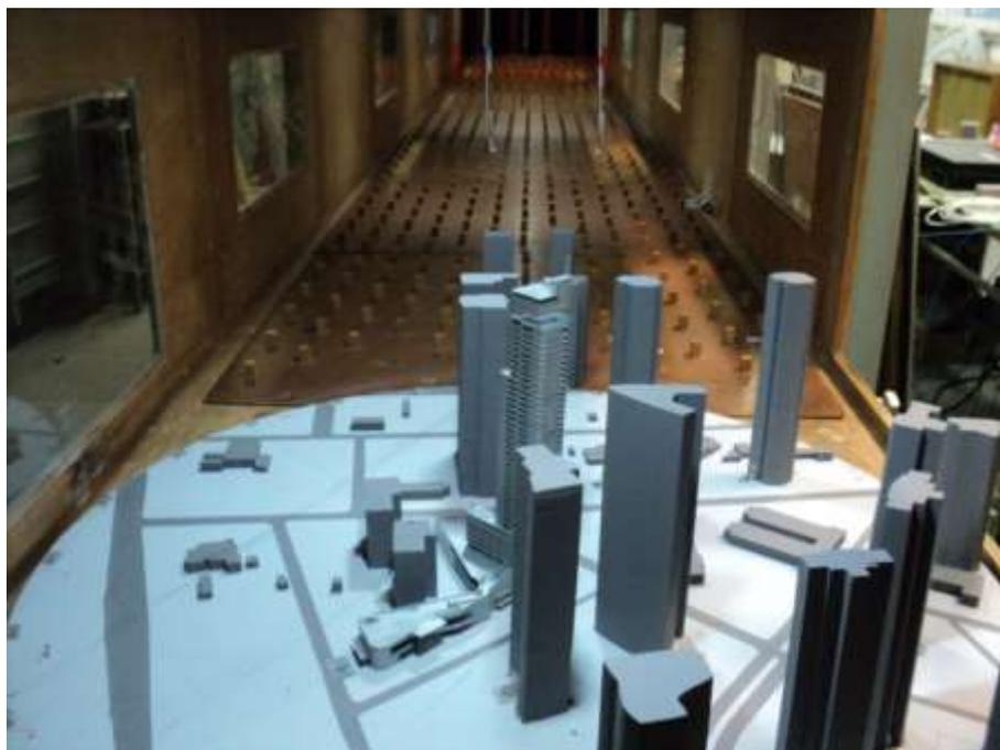
Figura 95: Modelo **M2, adensamento recente**, no interior do túnel de vento, ensaio **M2.150<sup>º</sup>**, expoente **p 0,23**; visualização dos instrumentos de medição, par de sondas de fio quente fixadas em suportes, no centro e acima da imagem.
