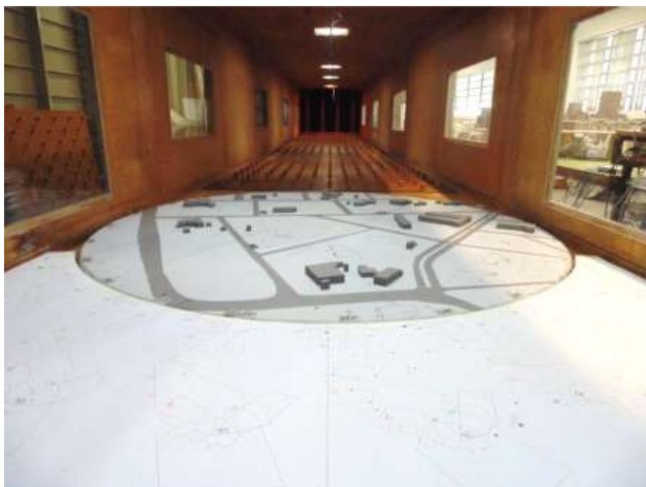
Figura 86: Modelo **M1**, **adensamento antigo**, no interior do túnel de vento, ensaio **M1.150<sup>0</sup>**, , expoente  $p$  **0,23**; visualização do tubo de Pitot Prandtl ao centro e acima.
