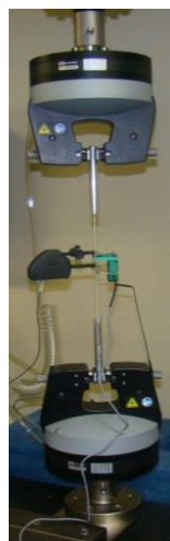
Figura 15 - Corpo de prova de fio de material compósito polimérico em ensaio de tração.
