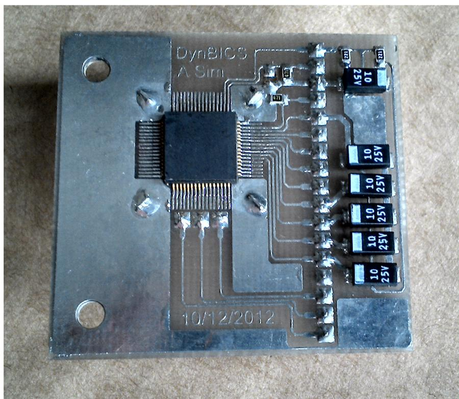
**Figura 29 Placa-protótipo contendo o circuito integrado submetido ao ensaio de Dose Total Irradiada.**
