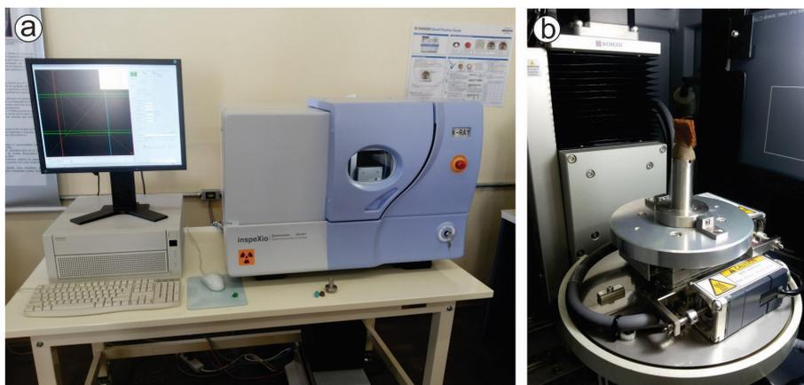
a) Equipamento de microtomografia de Raios-X inspeXio SMX-90CT; b) amostra da bainha fibrosa no porta amostra. Fonte: Autora (2018).
