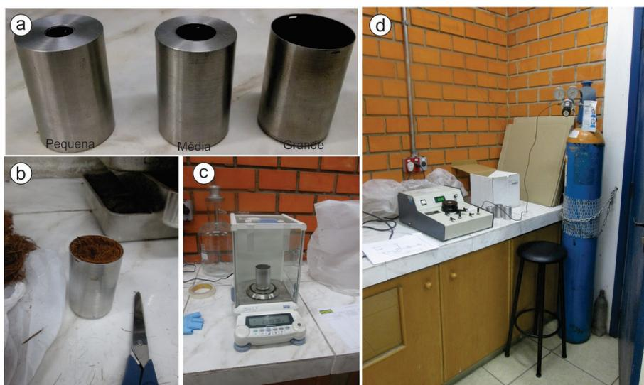
a) Porta amostras disponíveis para o ensaio (pequena com volume de 5,89 cm<sup>3</sup>, média com 11,42 cm<sup>3</sup> e grande com 88,63 cm<sup>3</sup>); b) porta amostras grande preenchido com a bainha fibrosa; c) porta amostra preenchido com a bainha fibrosa sendo pesado; d) Multipicnometro utilizado no ensaio. Fonte: Autora (2018).
